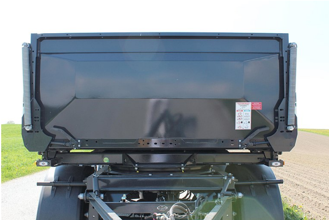
Rögzített acéllemez mellfal
