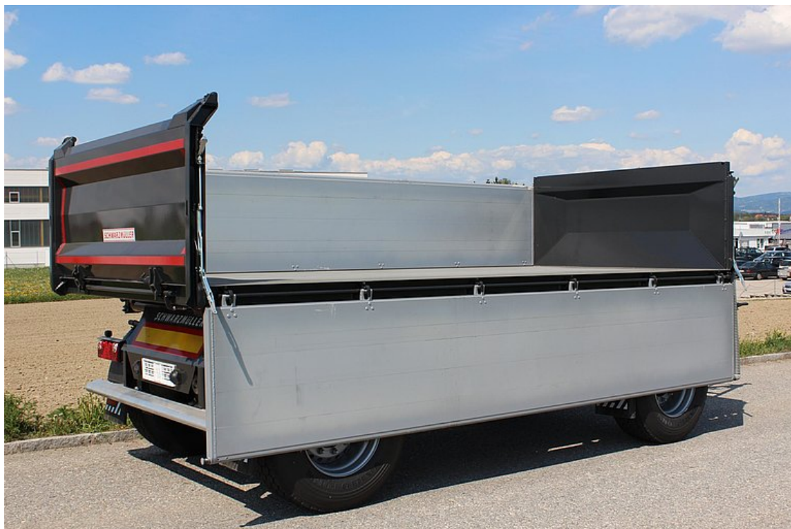
2-tengelyes, 3-oldalra billenő pótkocsi - kibillentett oldalfallal
