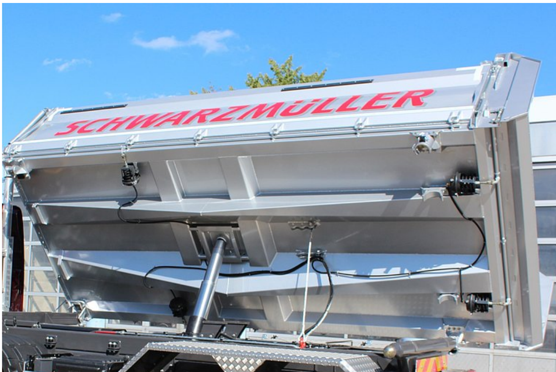
Magas szilárdságú, könnyített építésű felépítménykonstrukció kónikus trapéz formájú hossztartókkal, erőelnyelés és nagyobb szilárdság kisebb mezőkre osztott padlóval
