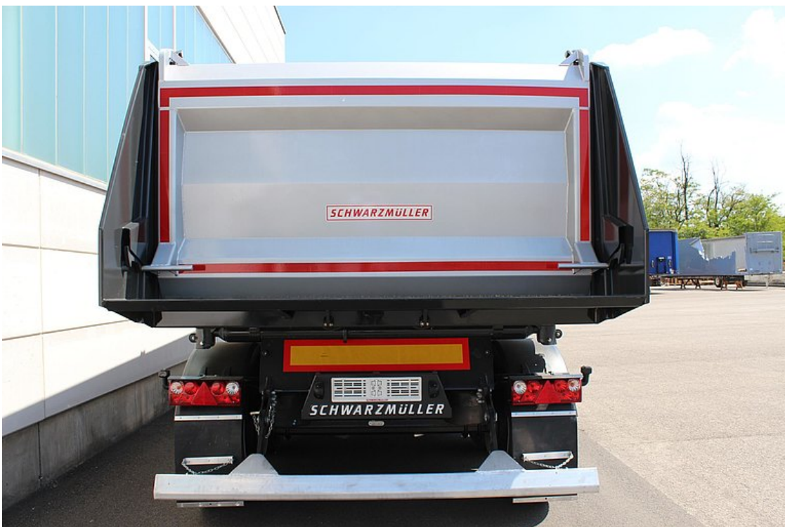
Kibillenő, acél hátfal, magasított csapágyazással és automatikus pneumatikus zárral
