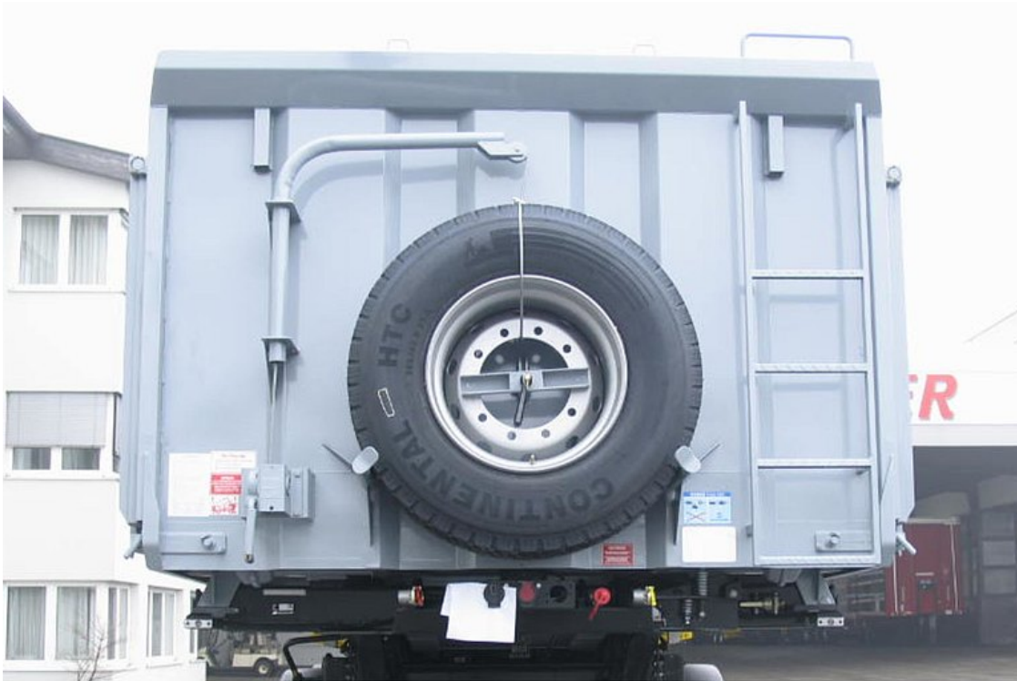
OPCIONÁLIS: csörlős kialakítású pótkeréktartó a mellfalon
