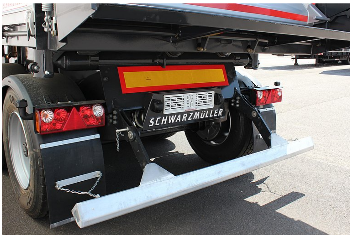
Felhajtható hátsó aláfutásgátló, Finisher használathoz
