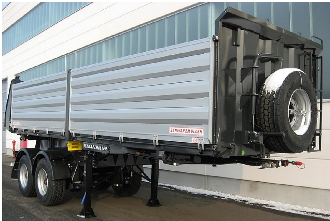
2-tengelyes, 3-oldalra billenő pótkocsi - építőipari kivitel
