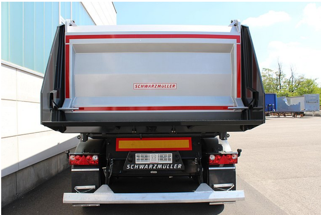
Kibillenő, acél hátfal, magasított csapágyszáccsal és automatikus pneumatikus zárral
