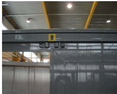
Schrauben der Drehstangenverschlüsse oben und unten auf Festsitz prüfen
