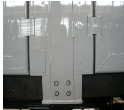
Schraubbefestigung der Säulen vorne, mitte, mitte unten und hinten auf Festsitz prüfen
