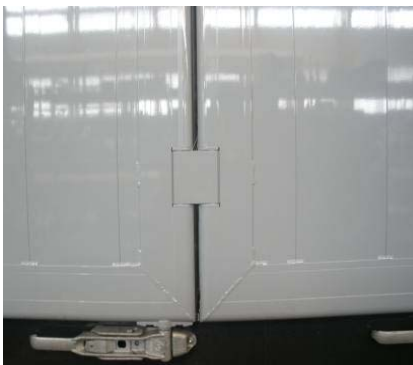
Scharniere auf Spiel und Schweißnähte auf Risse prüfen
