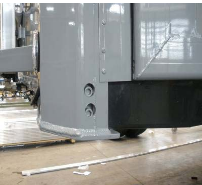
Schraubbefestigung der Säulen vorne, mitte, mitte unten und hinten auf Festsitz prüfen
