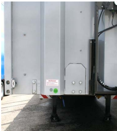
Vorderwand unten: Alle Schrauben auf Festsitz prüfen
