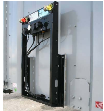
Gerätehalter: Schrauben und Nieten auf Festsitz prüfen
