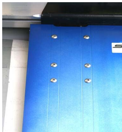
Ecksäulen hinten: Nieten auf Festsitz prüfen
