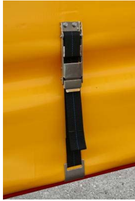
Flachhaken: Nieten auf Festsitz, Gurt auf Beschädigung prüfen
