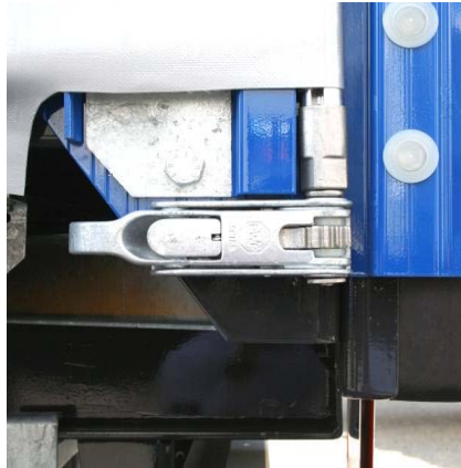
Spanngetriebe hinten: auf ordnungsgemäße Funktion prüfen, Adapter für Planenspannrohr auf Beschädigungen prüfen
