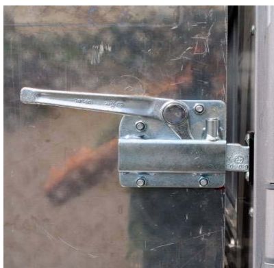
Alle Nieten und Schrauben der Verschlüsse und Verschlussaufnahmen auf Festsitz prüfen
