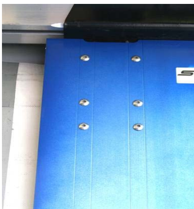
Ecksäulen hinten: Nieten auf Festsitz prüfen
