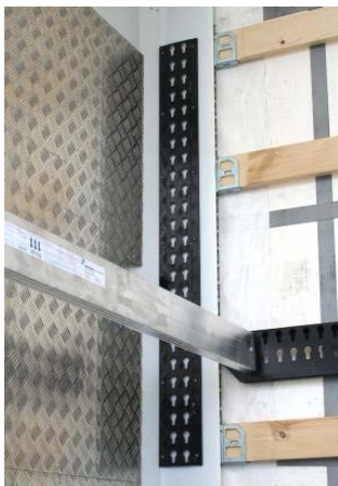
Ecksäule vorne: Nieten der Schiene auf Festsitz prüfen
