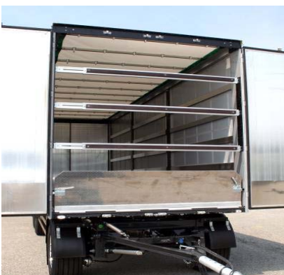
Alle Nieten und Schrauben der Querbalken und seitlichen Schienen auf Festsitz prüfen
