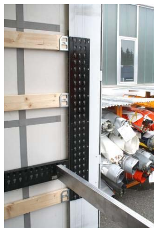
Ecksäule hinten: Nieten der Schiene auf Festsitz prüfen
