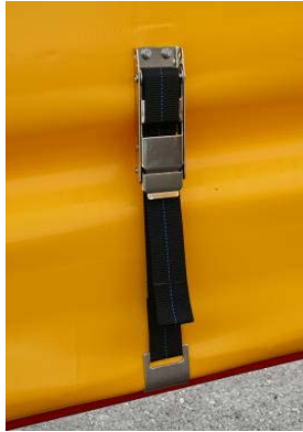
Flachhaken: Nieten auf Festsitz, Gurt auf Beschädigung prüfen
