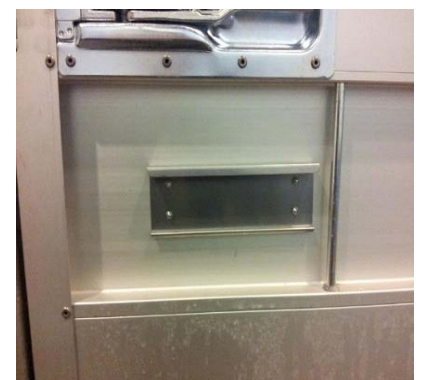
Quick-Slide Verschluss: Nieten auf Festsitz prüfen
