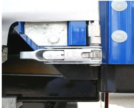
Spanngetriebe hinten: auf ordnungsgemäße Funktion prüfen, Adapter für Planenspannrohr auf Beschädigungen prüfen
