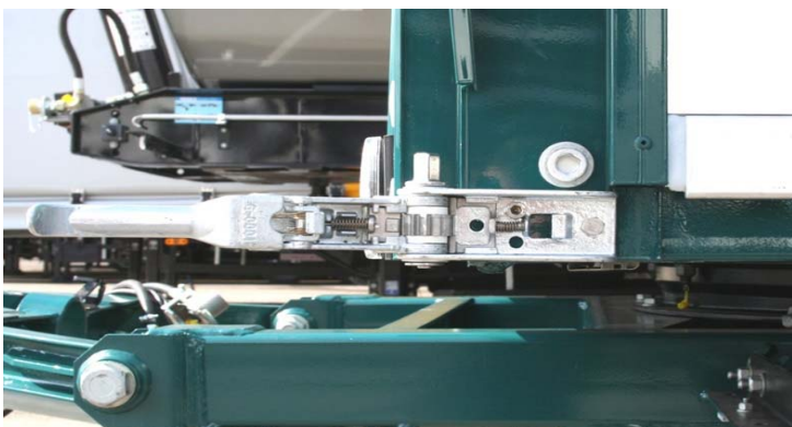
Verschraubung Ecksäule vorne auf Festsitz prüfen, Spanngetriebe auf ordnungsgemäße Funktion prüfen, Adapter für Planenspannrohr auf Beschädigungen prüfen
