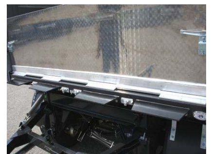
Schrauben der Scharniere auf Festsitz prüfen
