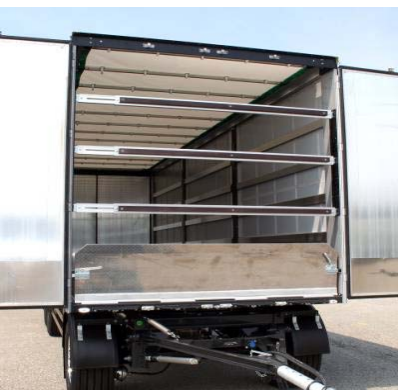
Alle Nieten und Schrauben der Querbalken und seitlichen Schienen auf Festsitz prüfen
