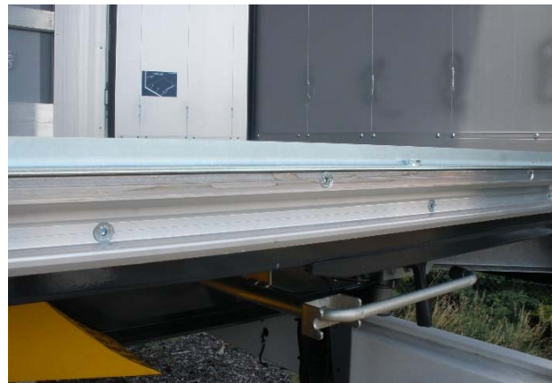
Führungsschiene unten auf Funktion und Verschleiß prüfen, Schraubverbindung auf Festsitz
