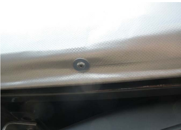
Vernietung der Seitenplane unten auf Festsitz prüfen
