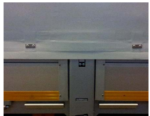
Quick-Slide-Spanner: Nieten auf Festsitz, Gurte und Spannelemente auf Beschädigung und Risse prüfen
