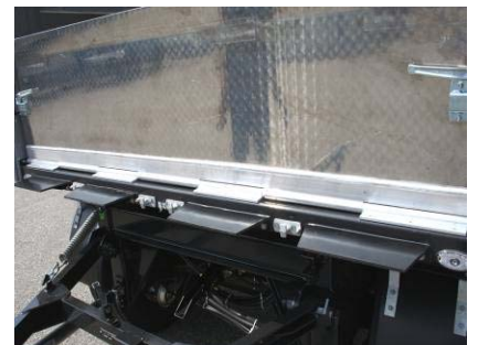
Schrauben der Scharniere auf Festsitz prüfen
