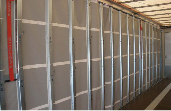
Quick Slider Sichtprüfung auf plastische Verformung etc.
