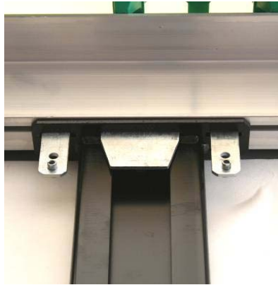
Laufwagen der Mittelsäulen: Nieten auf Festsitz prüfen
