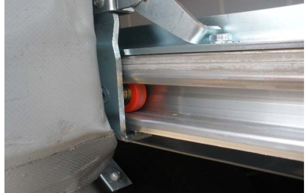
Gelenke und Laufwagen unten auf Funktion und Verschleiß prüfen, Schraubverbindung auf Festsitz
