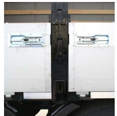
Bordwände: Nieten auf Festsitz prüfen
