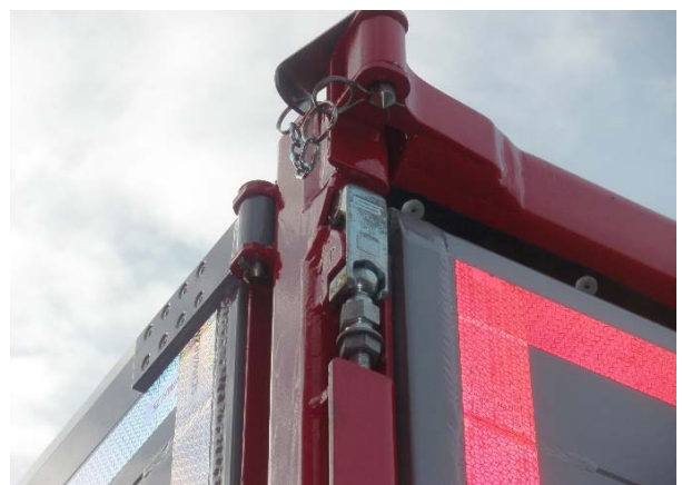
Rückwand zusätzlich schwenkbar: Sämtliche bewegliche Anbauteile wie Scharniere, Verschlüsse, Bolzen, Zapfen etc. auf Verschleiß und Funktion prüfen
