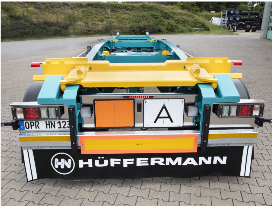
Abgesenkte Zuggabel bei Frontbeladung
