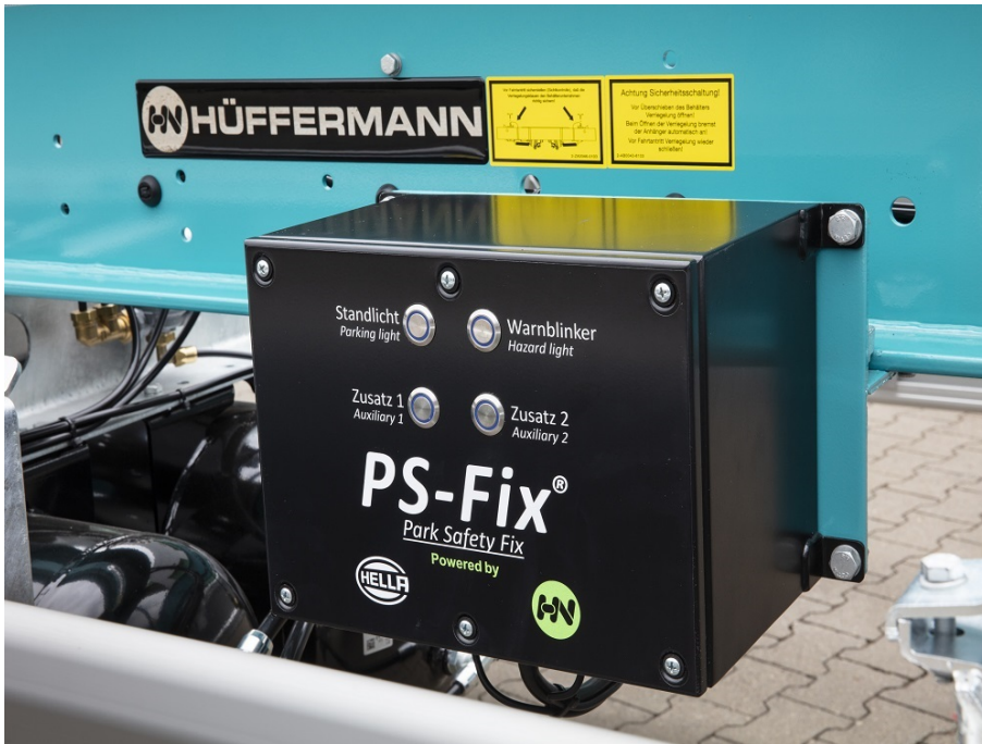
OPTIONAL: Autarkes Beleuchtungssystem für mehr Sicherheit
