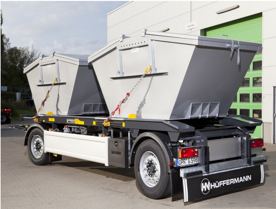
Kombinierte Ladungssicherung mit Zentrier-Fix und Zurrketten
