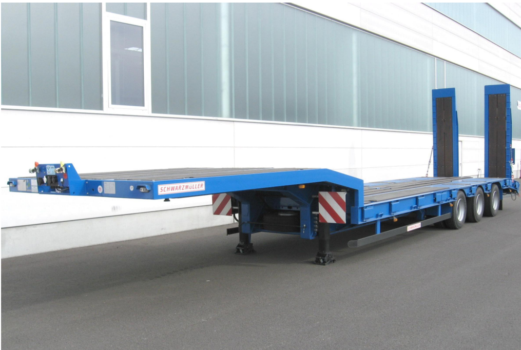
Tiefbettfläche und Kröpfungsbereich mit Weichholzboden
