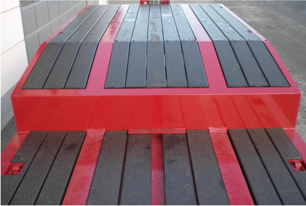
Tiefbettfläche und Kröpfungsbereich mit Weichholzboden
