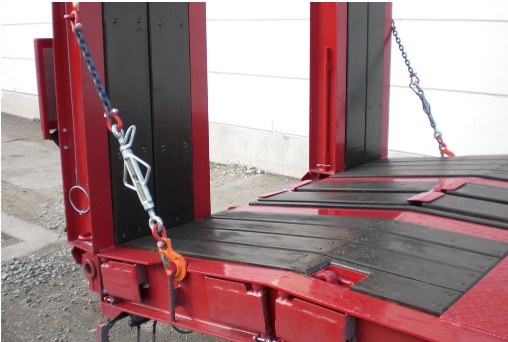
Zusätzliche Kettensicherung der Auffahrampen für sichere Transporte
