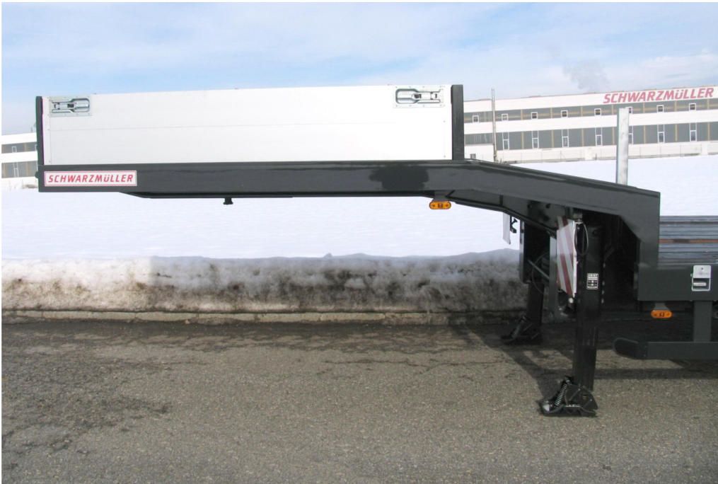
Vorne erhöhtes Kröpfungspaneau inkl. steckbare Bordwände
