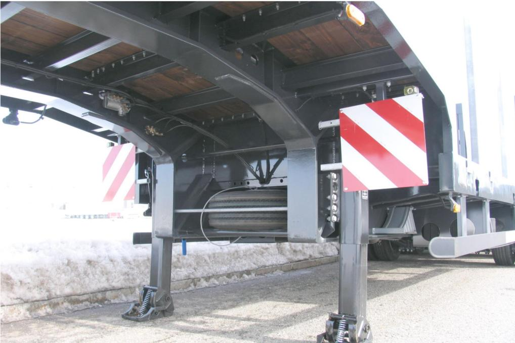
Verstärkte und verwindungssteige Stahlschweißkonstruktion mit engem Querträgerabstand für hohe Punktbelastung
