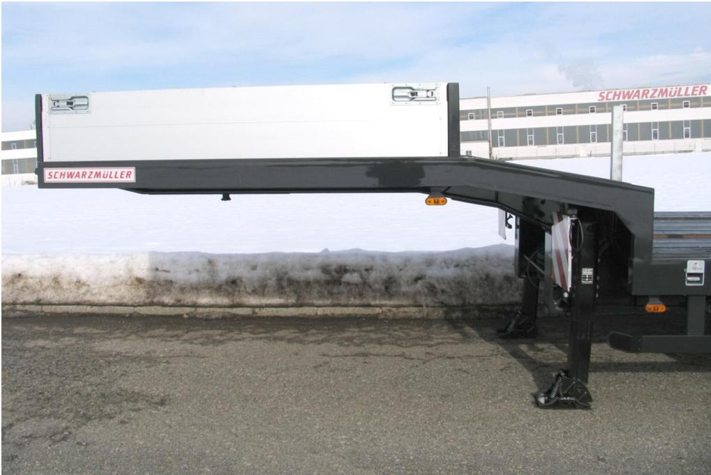
Vorne erhöhtes Kröpfungspaneau inkl. steckbare Bordwände
