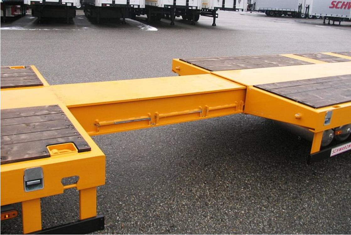
Ausziehbarer Zentralrahmen, stufenweise verstellbar mit pneumatischer Verriegelung
