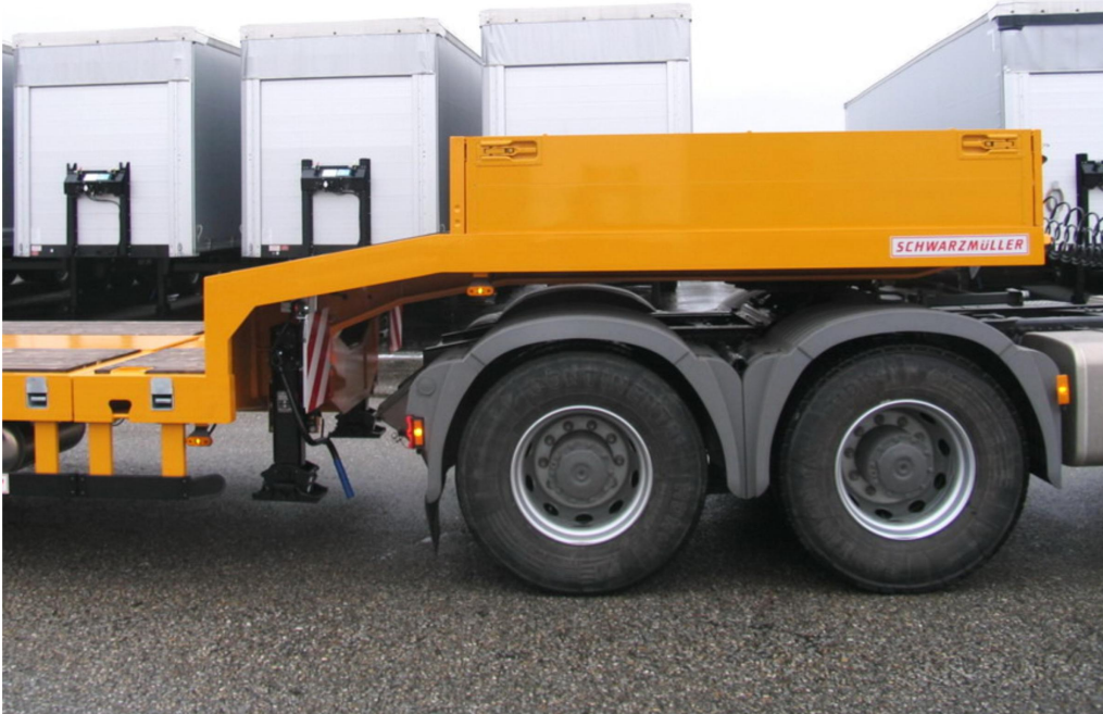
Vorne erhöhtes Kröpfungspaneau inkl. steckbare Bordwände
