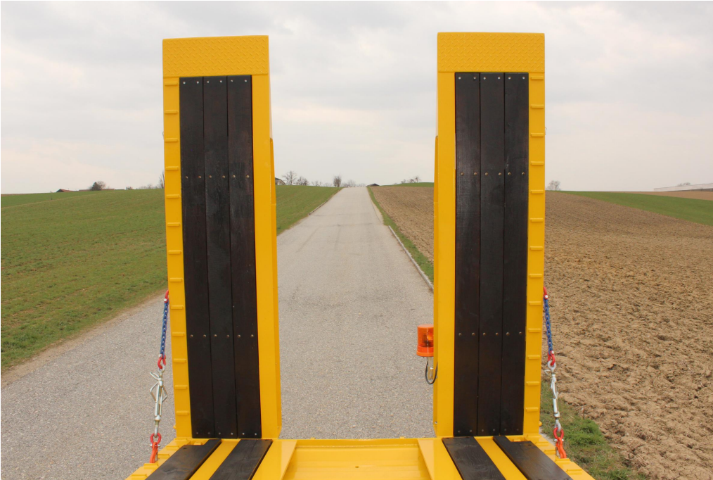
Auffahrrampen mit Hartholzbelag und aufgeschweißten Vierkantrippen
