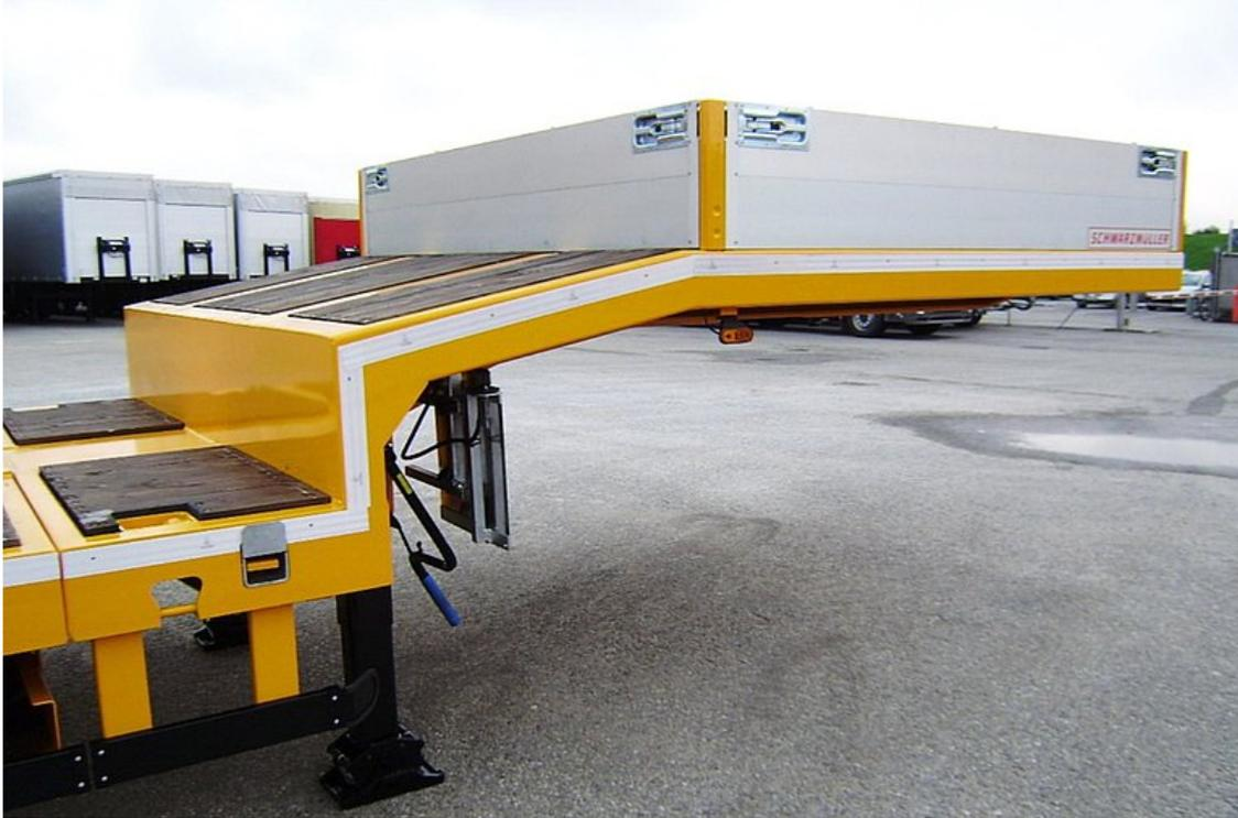
Vorne erhöhtes Kröpfungspaneeau inkl. steekbare Bordwände
