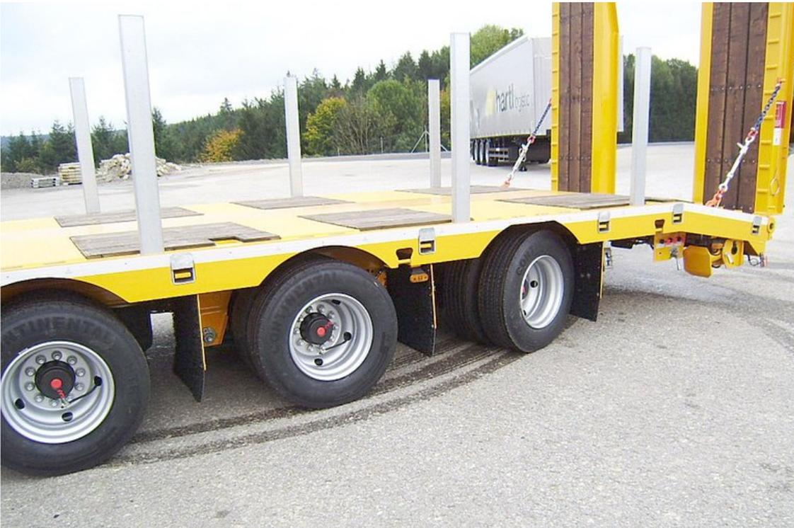
3. Achse nachlaufgelenkt für besseren Kurvenlauf und geringeren Reifenverschleiß
