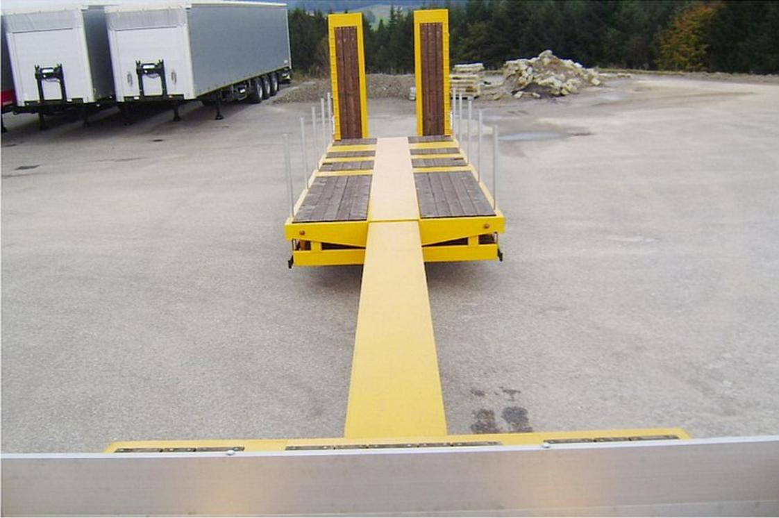
Tiefbettladefläche mit Weichholzboden samt Formrohrungen im Außenrahmen
