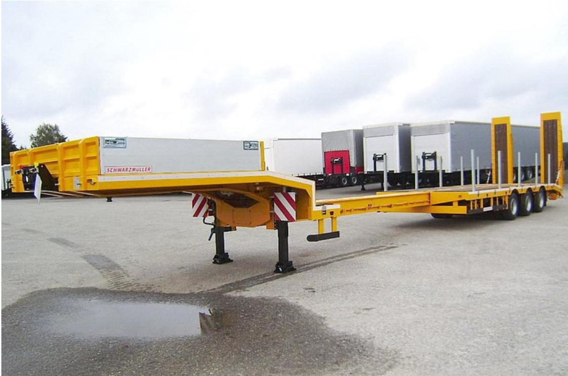
3-Achs-Tieffladesattelanhänger - verstärkt - ausziehbar
