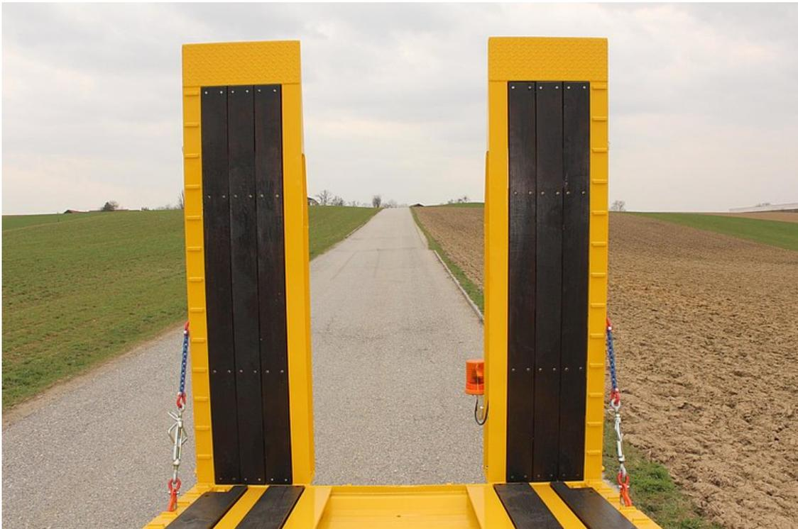
Auffahrrampen mit Hartholzbelag und aufgeschweißten Vierkantrippen
