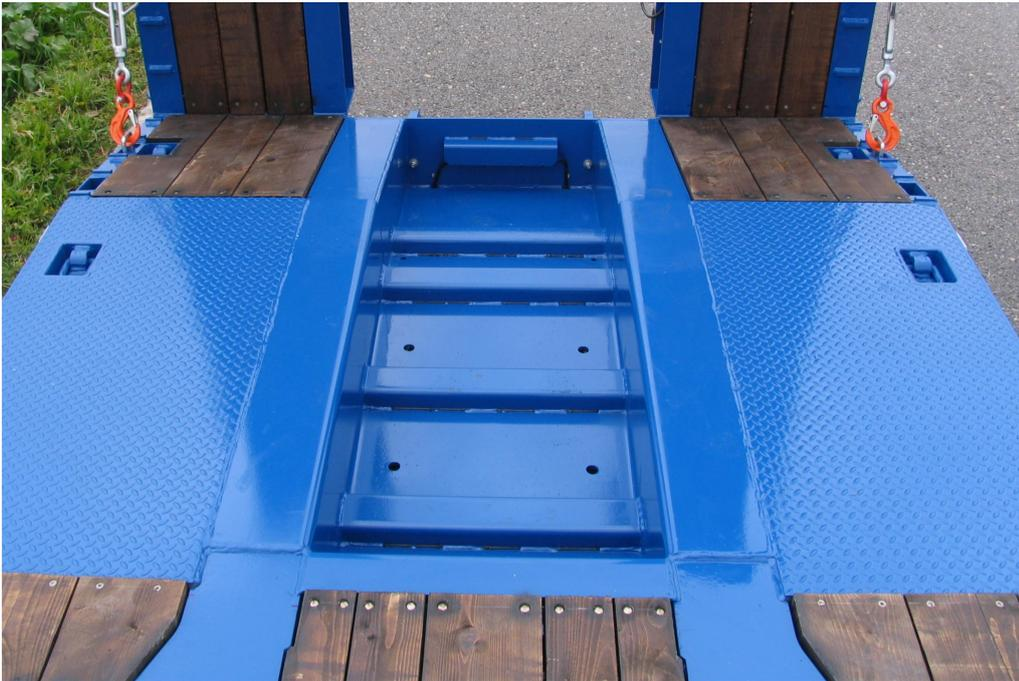
Baggerlöffelmulde - Vertiefung hinten zwischen den Längsträgern
