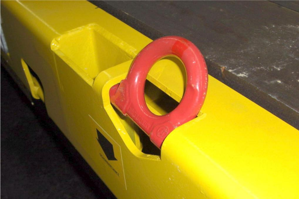
8 Paar versenkte hochklappbare 10 t Bodenzerringe (6 x im Tiefbett und 2 x am erhöhtem Plateau)
