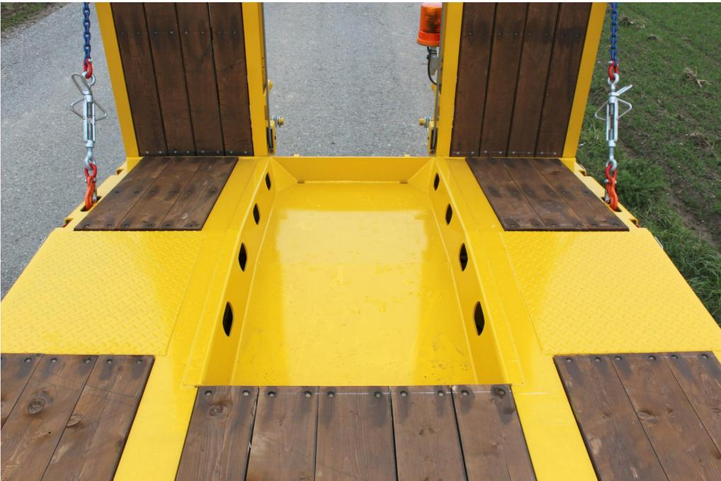
Baggerlöffelmulde - Vertiefung hinten zwischen den Längsträgern
