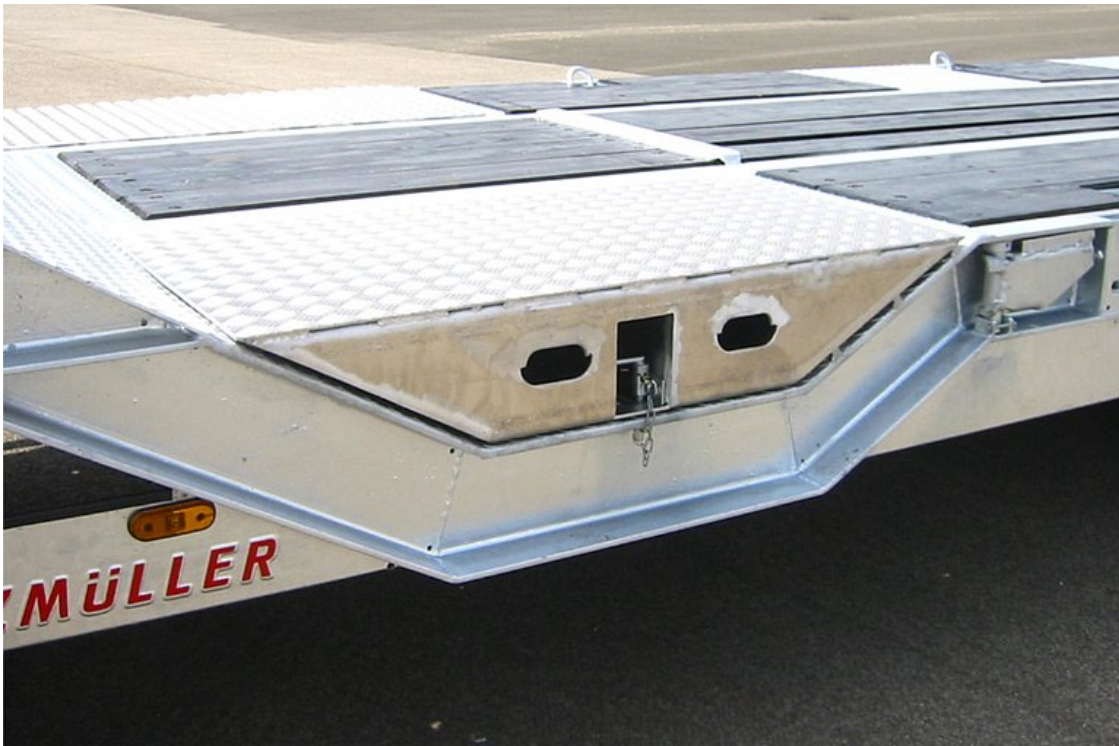
Radmulden in verschiedenen Ausführungen für den Transport von speziellen Baumaschinen
