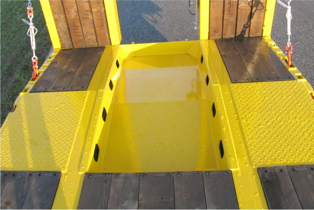
Baggerlöffelmulde - Vertiefung hinten zwischen den Längsträgern
