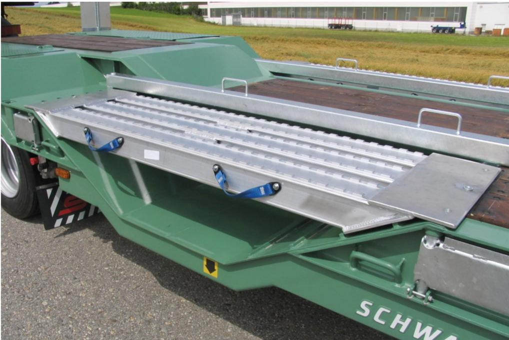
Radmulden in den Außenrahmen integriert, passend zur Bodenkonstruktion inkl. überfahrbarer Aluminium-Abdeckung
