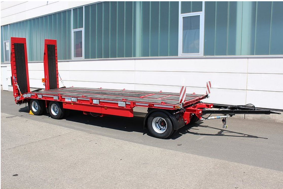
3-Achs-Tiefladeanhänger mit geradem Plateau
