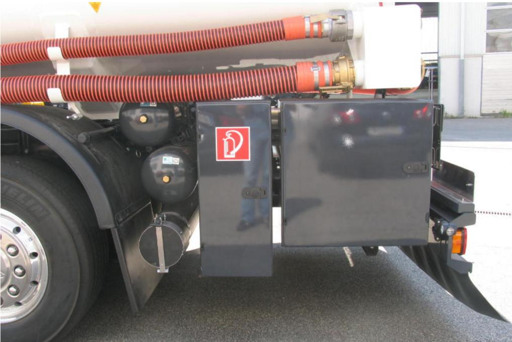
Aluminium-Kasten für 12 kg-Feuerlöscher und Zubehörkasten
