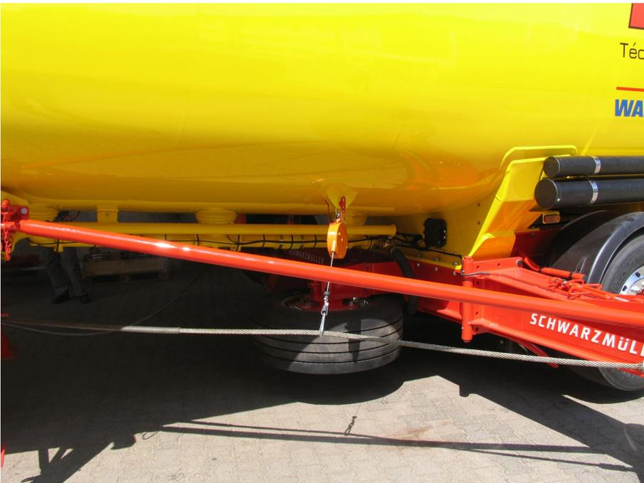
Knickschutzseile im Bereich der Auslegerabstützung zum Tank
