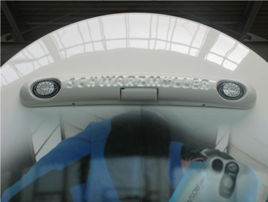
OPTIONAL: Hochgesetzter LED-Leuchenträger mit Möglichkeit einer integrierten Rückfahrkamera
