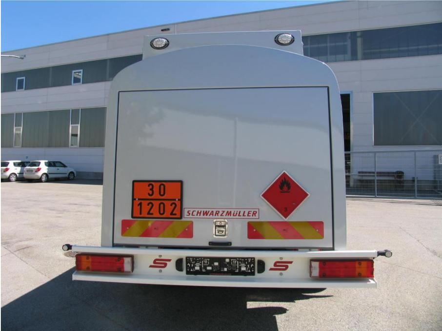
OPTIONAL: 2 hochgesetzte Rückleuchten im Heckschrank versenkt montiert
