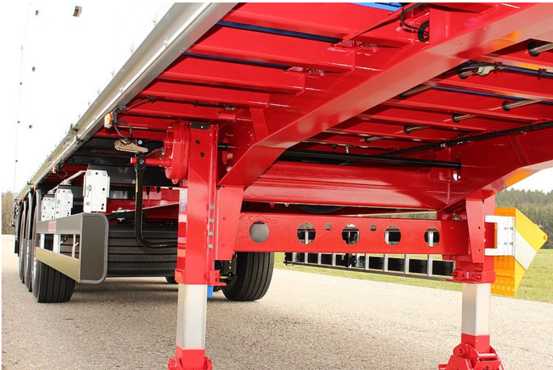
Verwindungssteife, durchgehende Stahl-Rahmenkonstruktion
