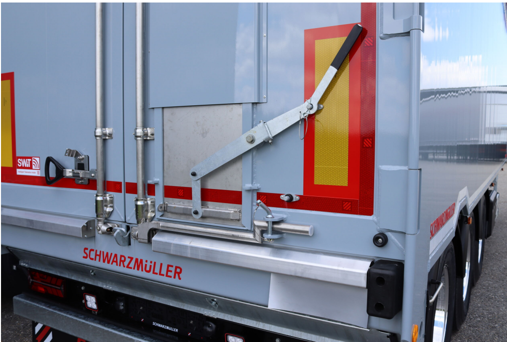
Planenschutzblech zum Schutz der Rollplane während des Beladevorganges
