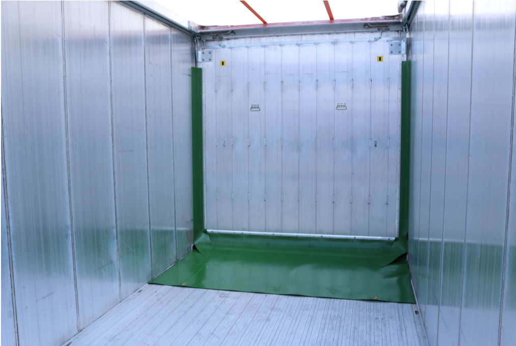
mitlaufende Zwischenwand für Restlosentleerung
