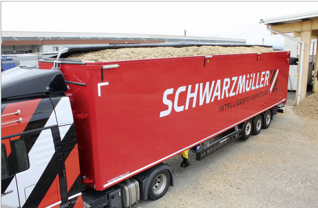
3-Achs-Schubboden-Sattelanhänger mit Aluminium-Rahmen optional mit elektrischem Rollverdeck
