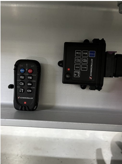
Funkfernbedienung mit Steuerung von Arbeitsscheinwerfern oder Liftachse
