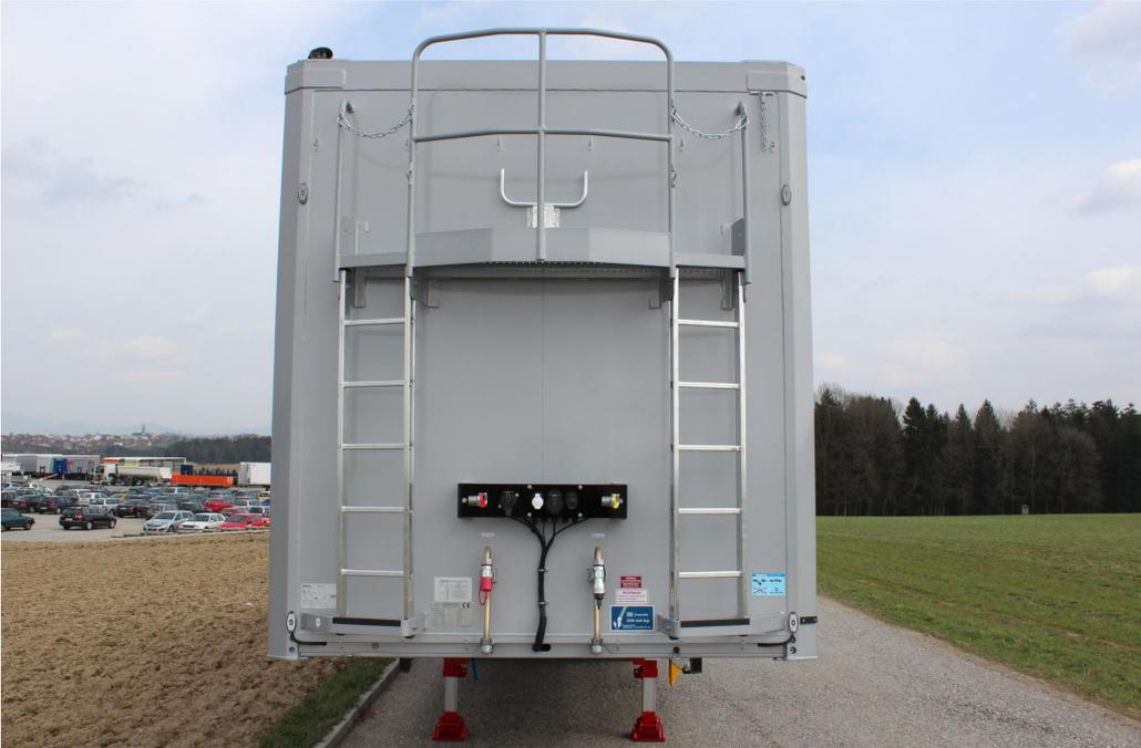
Aluminium-Hohlprofil-Vorderwand feststehend mit oberem Stabilisierungsrahmen
