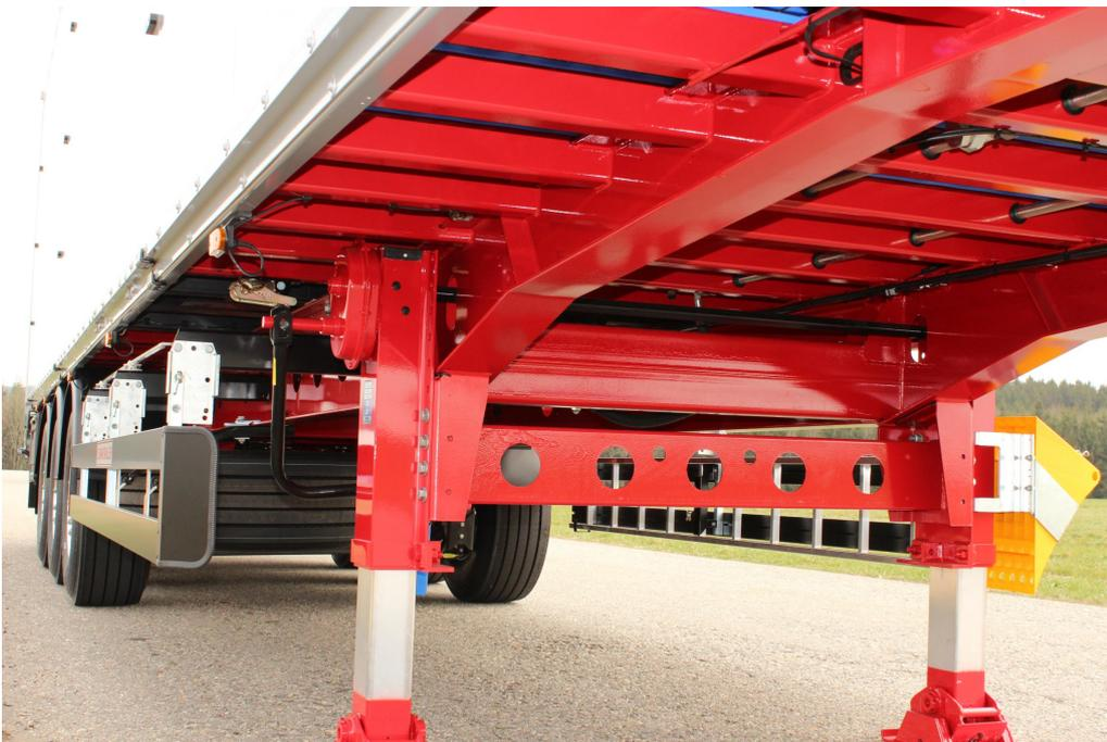
Verwindungssteife, durchgehende Stahl-Rahmenkonstruktion
