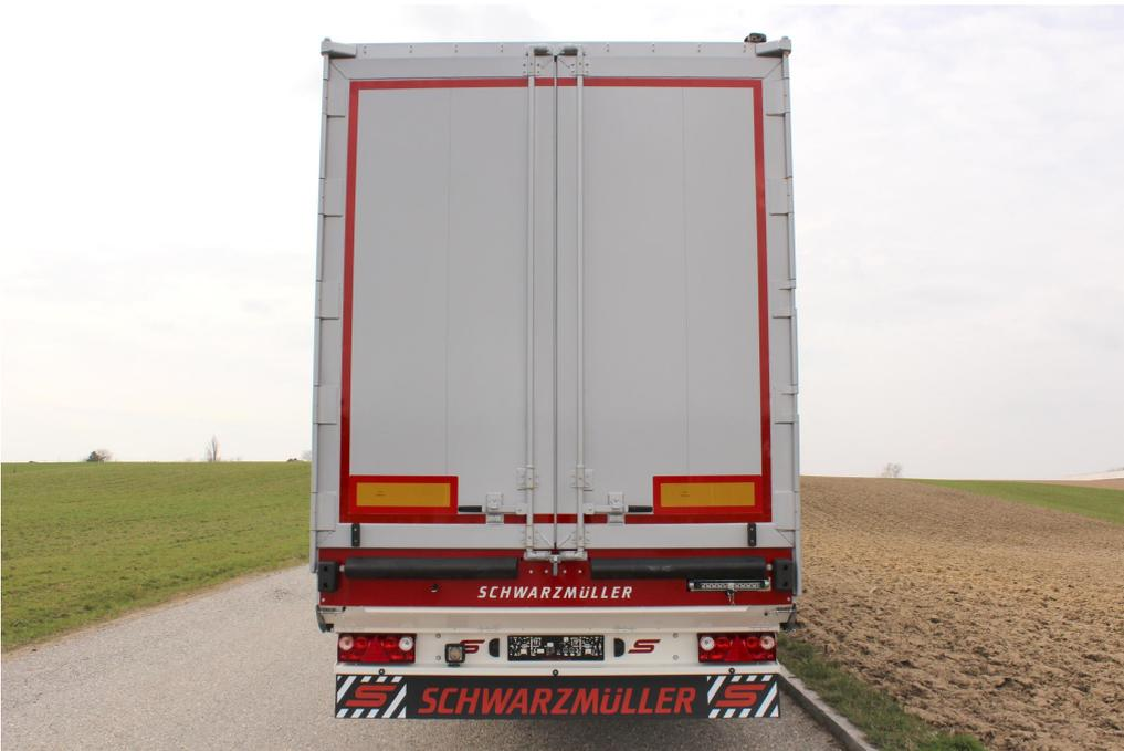
Rückwand = Doppelflügeltüre mit je 1 außenliegendem Drehstangenverschluss pro Türflügel und zus.
