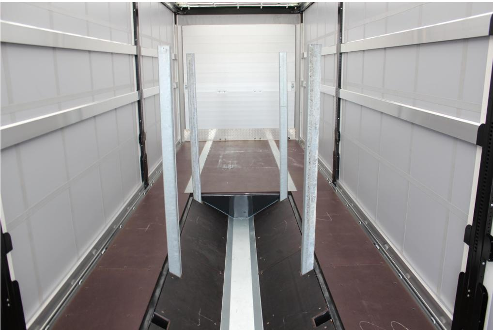
OPTIONAL: Coilmulde = Nutzlänge ca. 7.400 mm - Ausführung nach VDI 2700 für Coilsdurchmesser 900 bis max.
