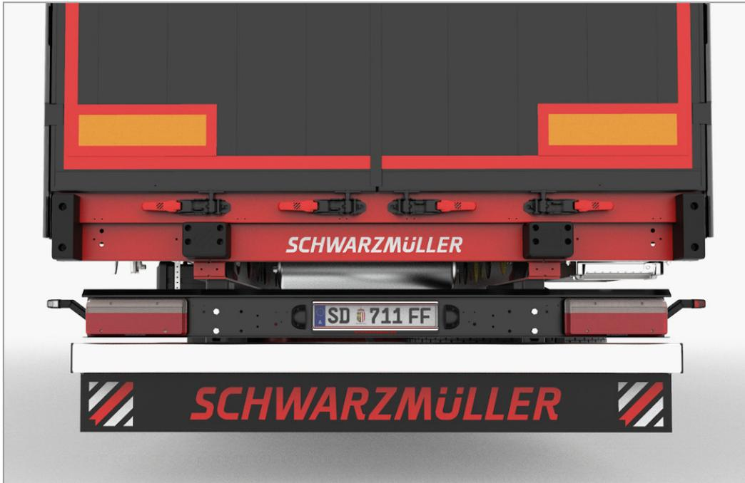
Unterfahrerschutz: Verhindert das Unterfahren des Fahrzeuges an der Rückseite und entspricht jetzt schon der neuen EU-Regelung ab 2021 mit erhöhten Prüfkräften.
