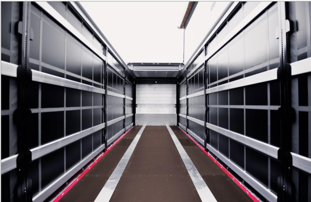
Kraftorientierter Siebdruckboden: 28 mm stark und für eine Staplerachslast von 7.200 kg geeignet.
