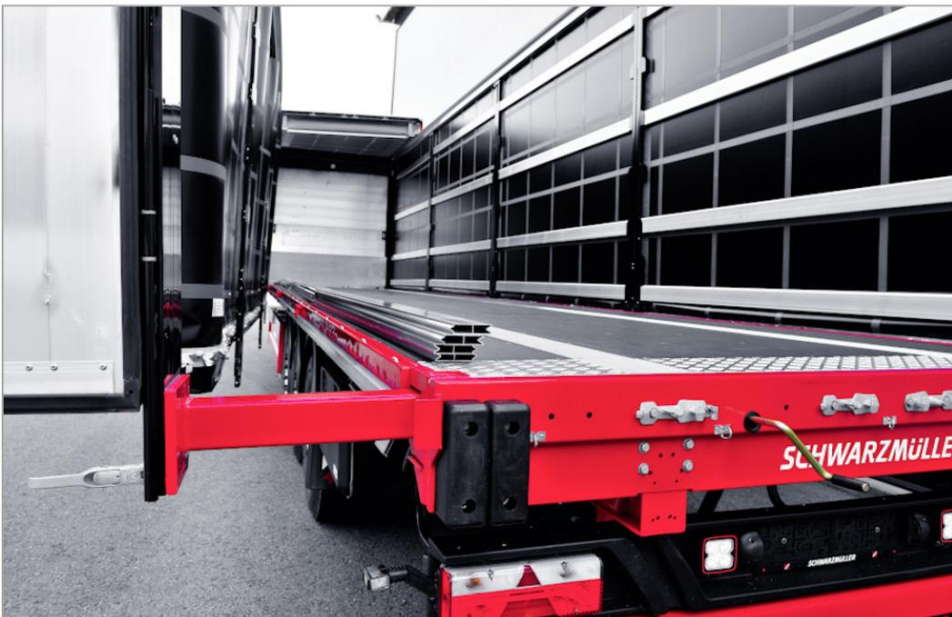
OPTIONAL: Auskurbelbarer Portalrahmen: Um mehr Einladebreite an der Rückseite zu generieren, können die hinteren Ecksäulen seitlich ausgekurbelt werden.
