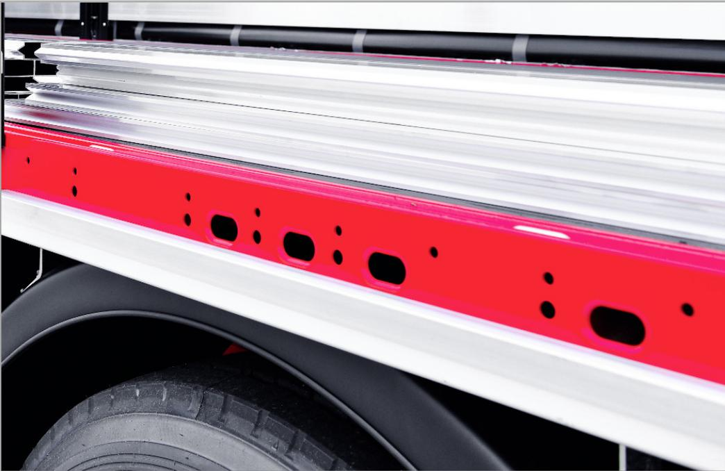
Lochaußenrahmen: Zusätzlich zu den Zurrbügeln lassen sich am Lochaußenrahmen an jeder gewünschten Position Sicherungshaken für die Ladung anbringen.
