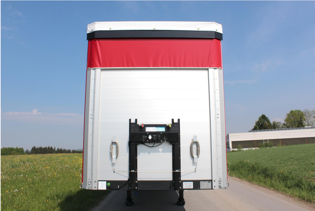
Verstärkte Aluminium-Hohlprofil-Vorderwand mit integriertem Gerätehalter
