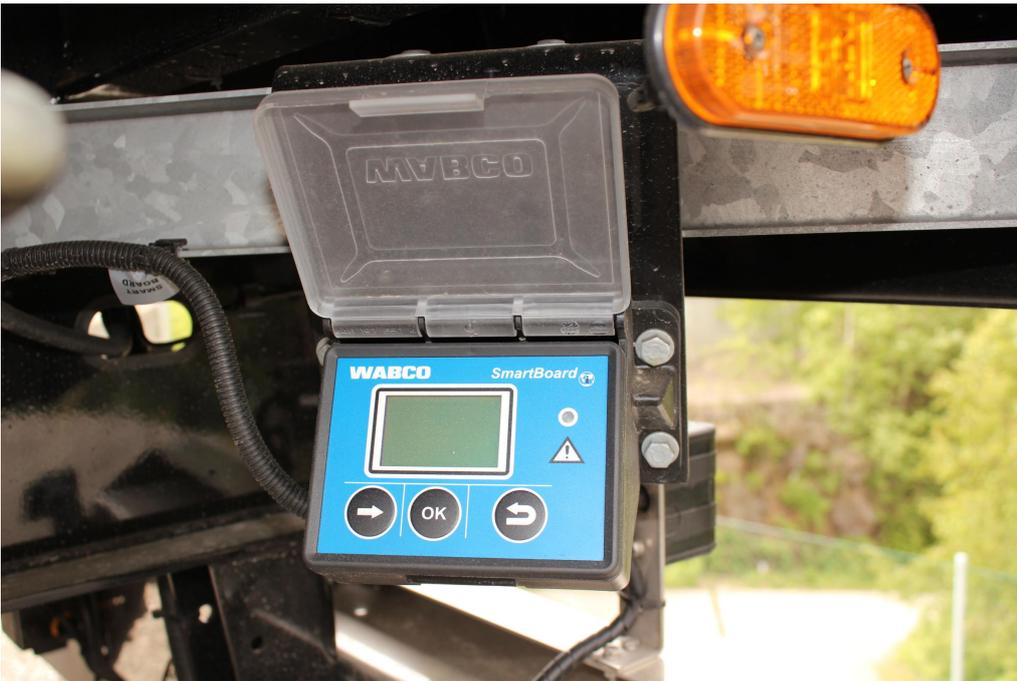
OPTIONAL: SmartBoard von Wabco = Auslese der Daten über Display am Fahrzeug (Kilometerstand, Achsaggregatlast, Bremsdiagnose etc.)
