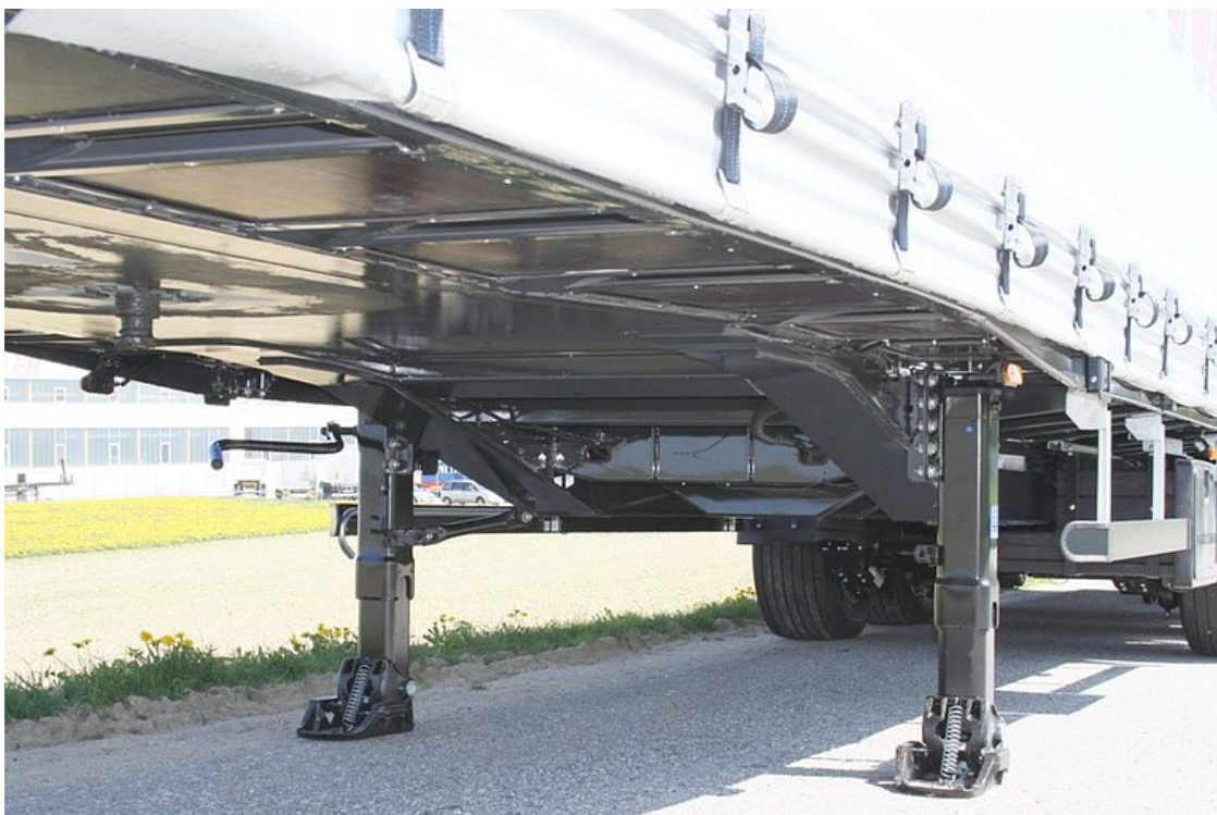
Verstärkte Rahmenkonstruktion für Coiltransporte 27 t im Schwerpunkt auf mindestens 2.000 mm Ladelänge
