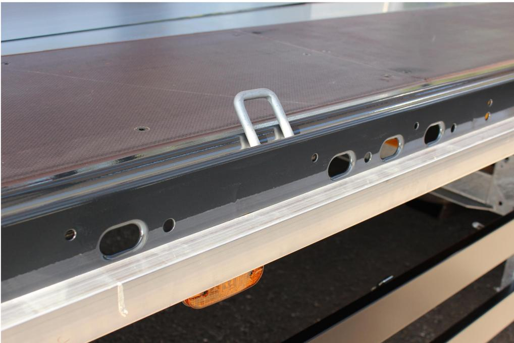
Loch-Außenrahmen mit Lochabstand ca. 100 mm, Langloch 40/25 mm nach DIN EN 12640 und 23 Paar versenkte
