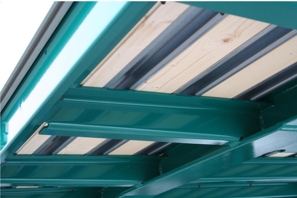
Doppelboden bestehend aus Stamboden mit integrierten Stahl-Omegaschienen und darüber mit Siebdruck-Verschleißboden (Staplerachslast 7 t)
