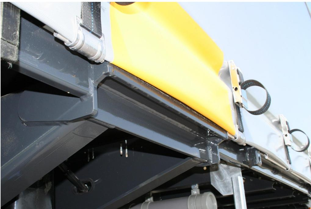
Rahmenkonstruktion verstärkt mit 4 Greifkanten für kranbare Bahnverladung
