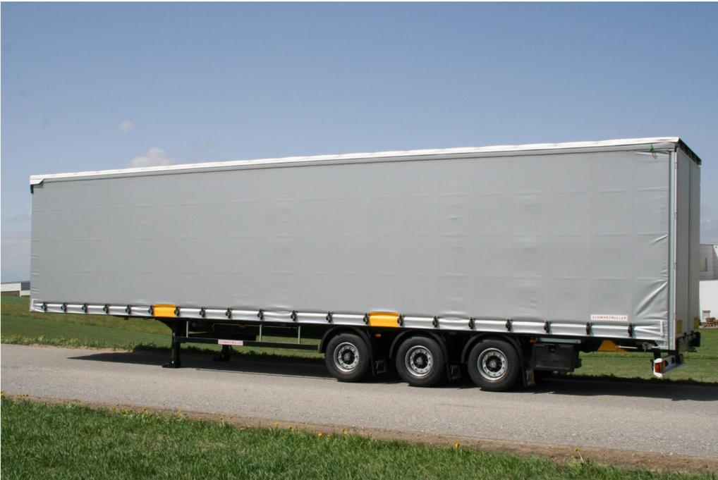
Korrosionsarme hochwertige Aluminium-Aufbaukomponenten, geprüft nach EN 12642 XL
