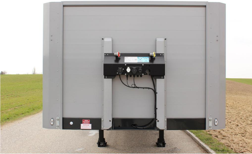
Fixe Aluminium-Hohlprofil-Vorderwand mit 2 Mittelstützen, innen 2 Stk. Zurringe für Ladungssicherung und mit Stahlblech verstärkt
