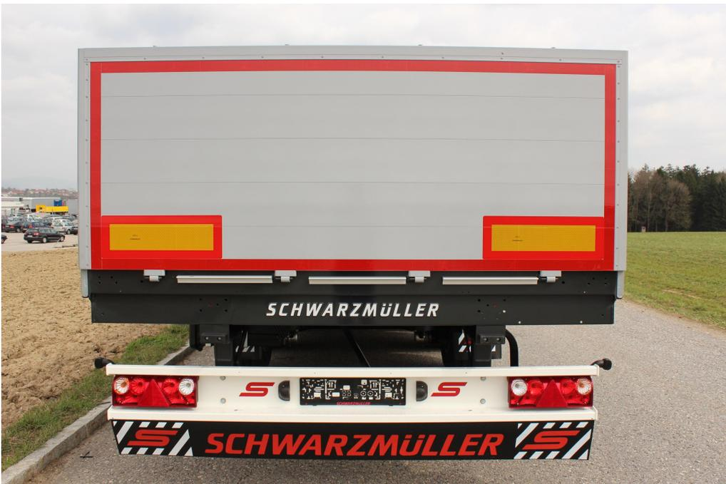
Abklappbare Aluminium-Hohlprofil-Rückwand, mit Gummiabdichtung senkrecht und waagrecht
