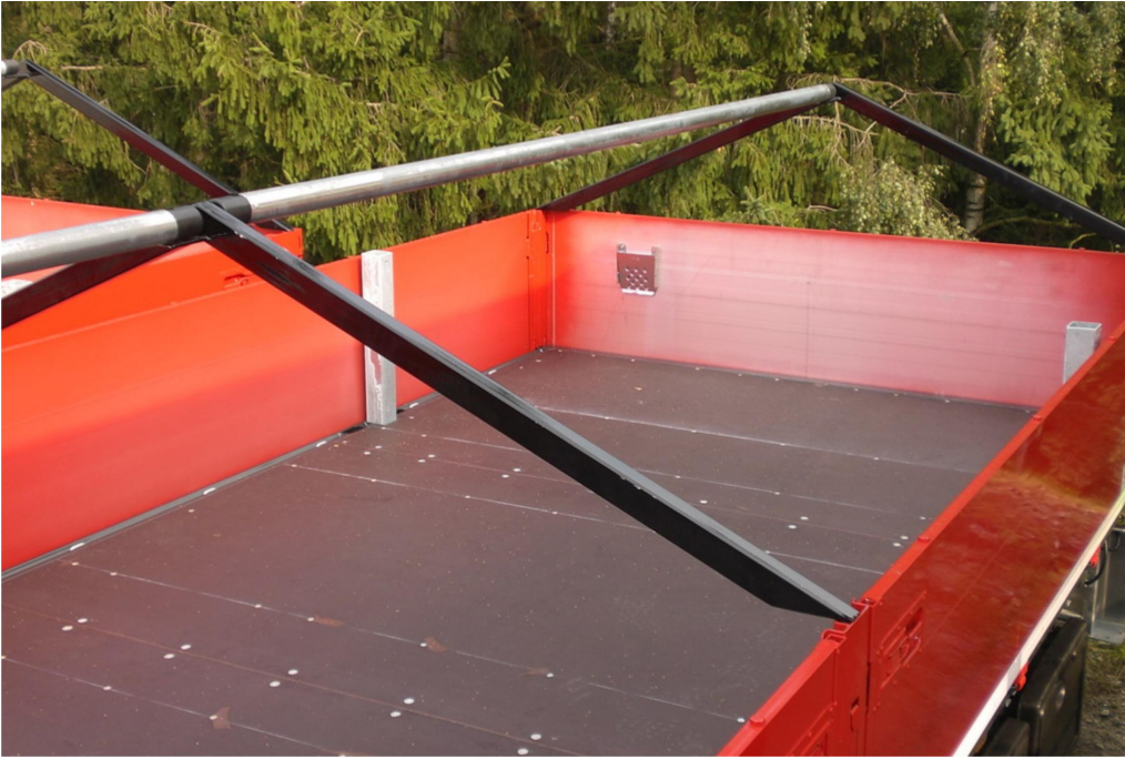
OPTIONAL: Zementverdeck - 4 Stk. Dachbögen direkt in die Mittel- und hinteren Ecksäulen eingesetzt und 1 Dachstangenreihe mittig (Dachneigung 500 mm)
