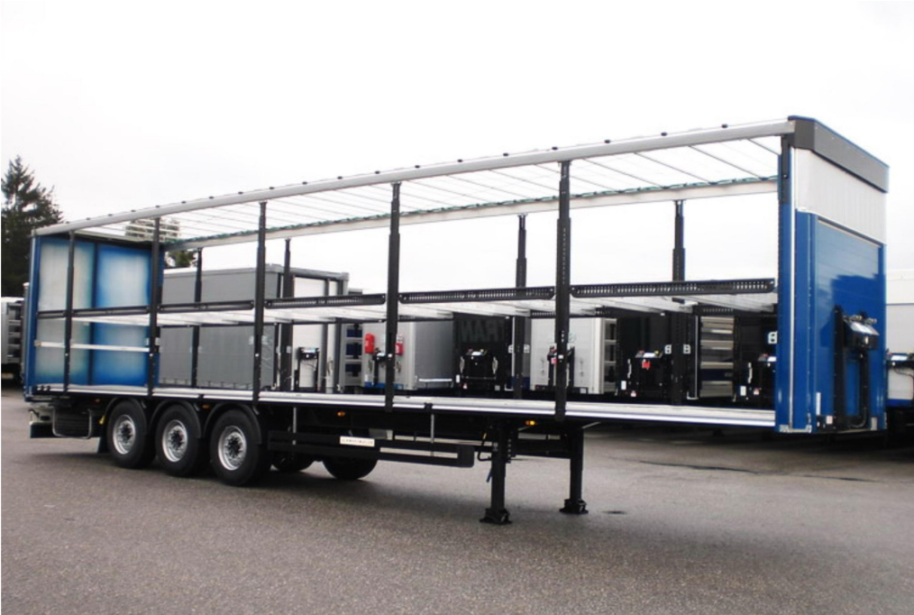
3-Achs-Schiebeplanen-Plateausattelanhänger mit Doppelstockverladeeinrichtung
