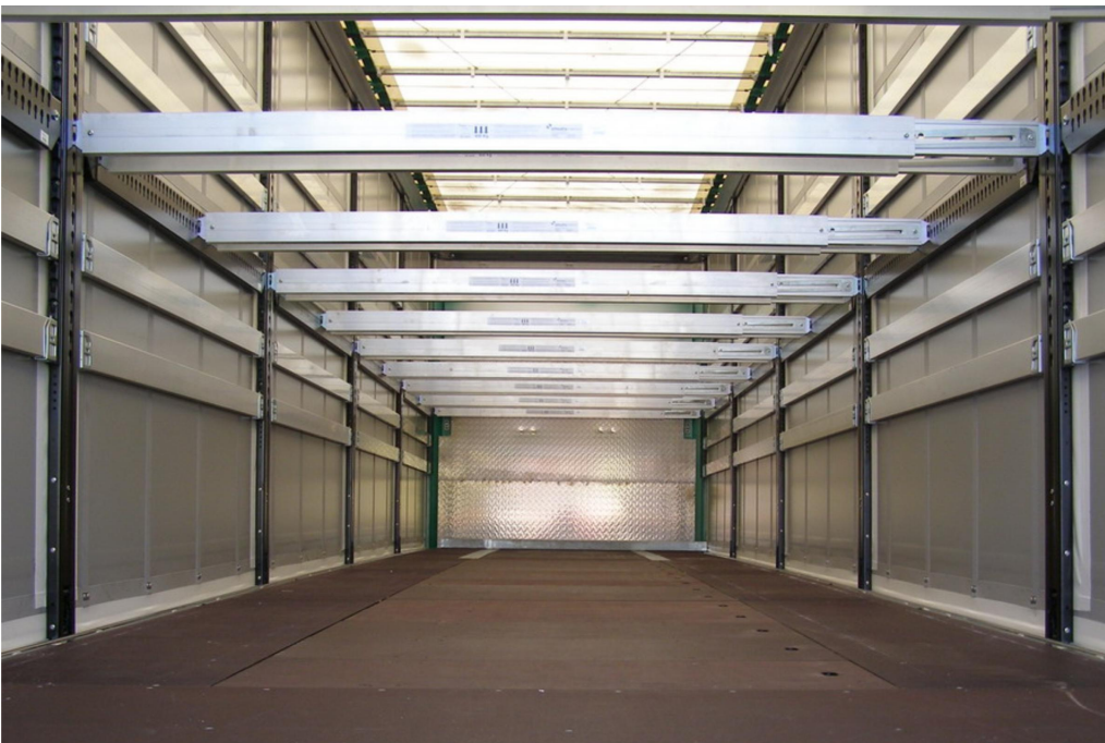
3-Achs-Schiebeplanen-Plateausattelanhänger mit Doppelstockverladeeinrichtung
