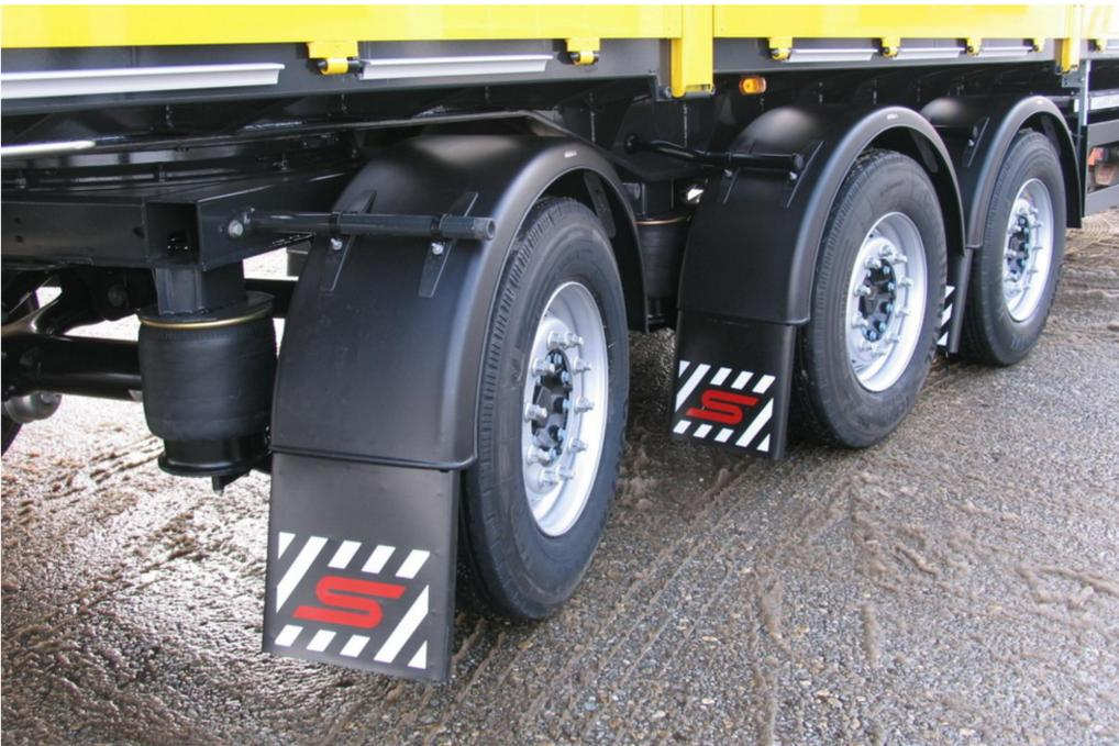
3. Aufliegerachse mit mechanischer Zwanglenkung
