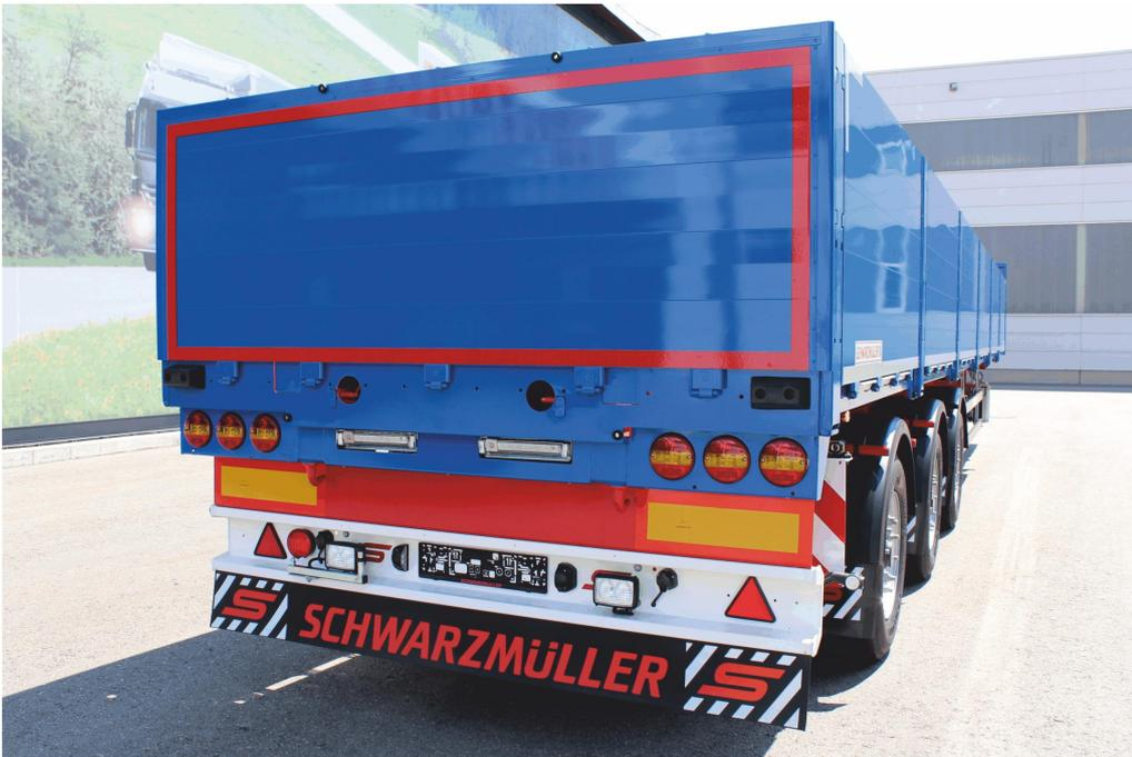
Verstärkte Aluminium-Hohlprofil-Rückwand 1.000 mm hoch
