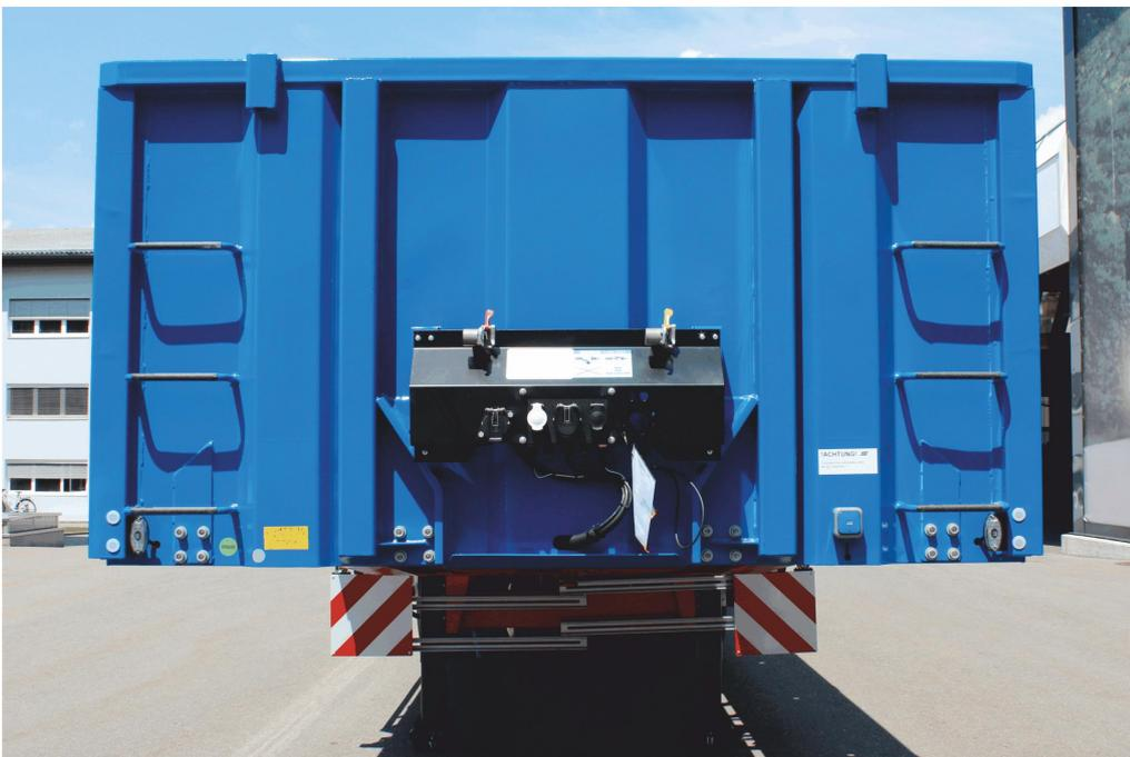
Fixe verstärkte Aluminium-Hohlprofil-Vorderwand stirnseitig angebaut
