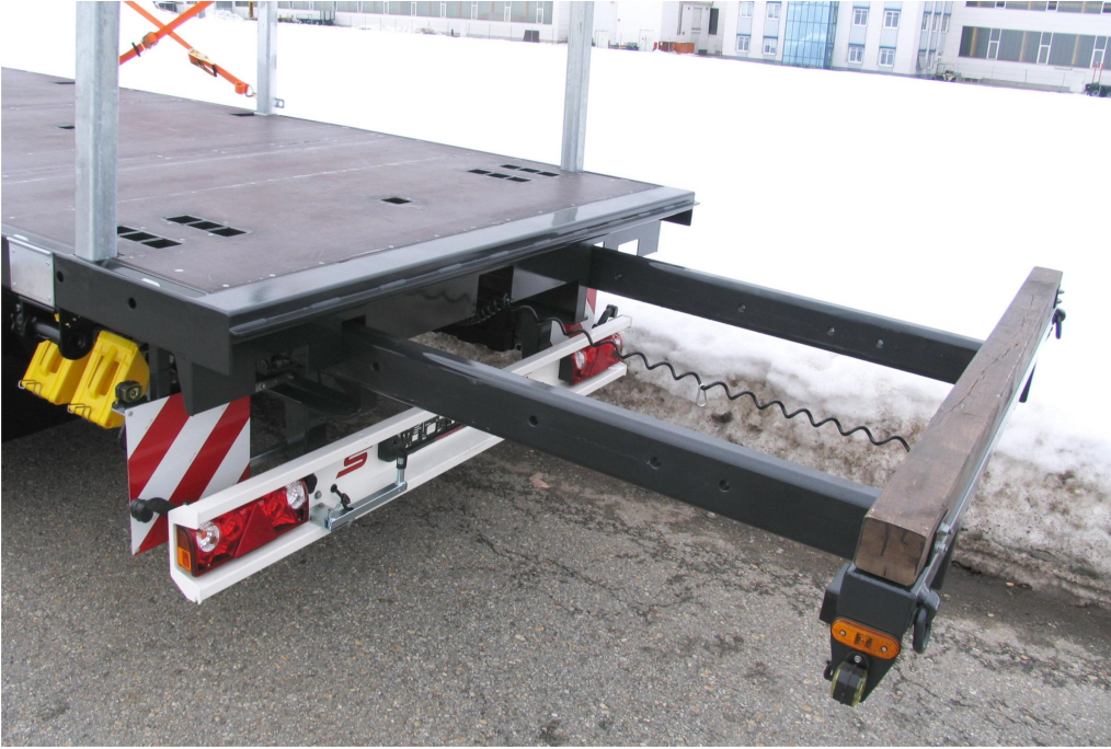
OPTIONAL: Rückwärtiges Ausziehgestell, 1.500 mm ausziehbar (2 t belastbar)
