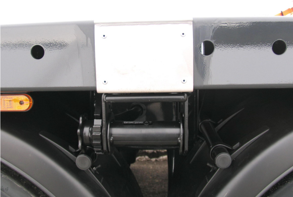
OPTIONAL: Rückwärtiges Ausziehgestell, 1.500 mm ausziehbar (2 t belastbar)
