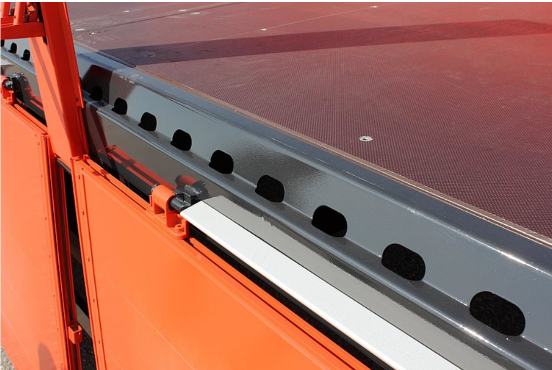
OPTIONAL: Lochaußenrahmen mit Lochabstand ca. 100 mm, Langloch 50/30 mm, für Verzurrung 2,5 t je Zurrpunkt
