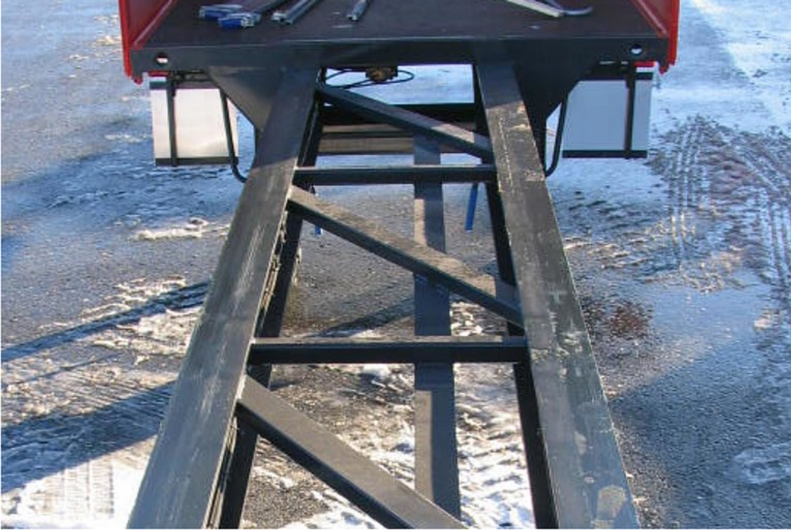
Ausziehbarer Leichtbaurahmen mit Ausziehlänge 6 m für Langmaterial-Transporte bis 22 m
