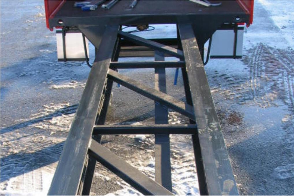
Ausziehbarer Leichtbauahmen mit Ausziehlänge 6 m für Langmaterial-Transporte bis 22 m
