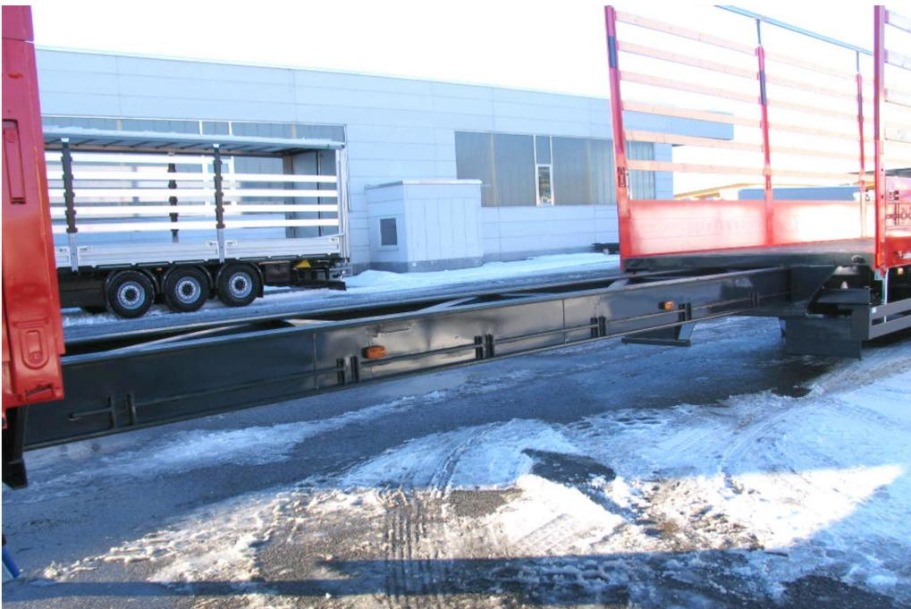
Verwindungssteife ausziehbare Stahlrahmensweißkonstruktion, mit 7-facher pneumatischer Verriegelung
