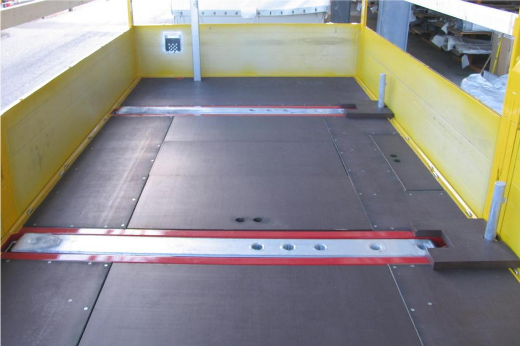
Ladefläche mit eingefahrener Schrägverladeeinrichtung
