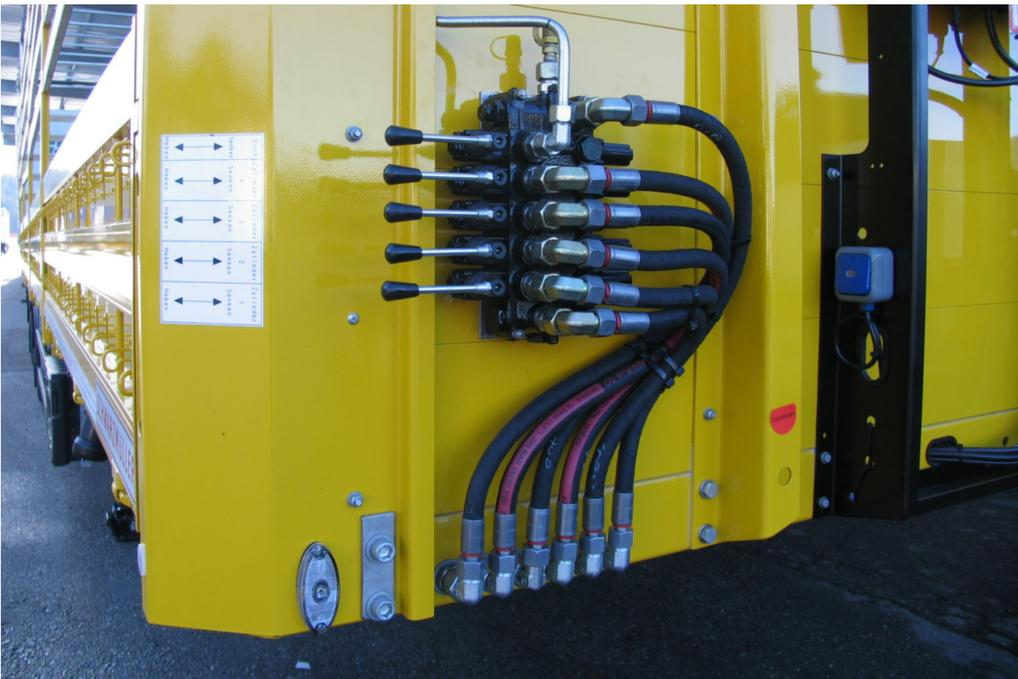
Hydraulische Steuereinheit für das Schrägverladesystem
