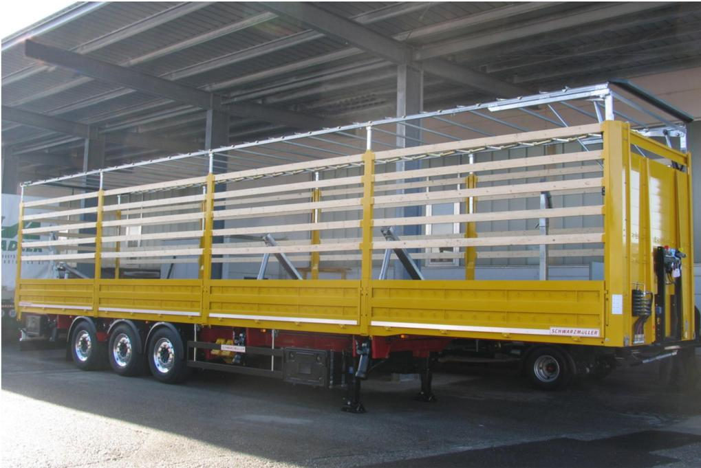
3-Achs-Leichtbau-Plateausattelanhängen - Coil - Schrägverlader
