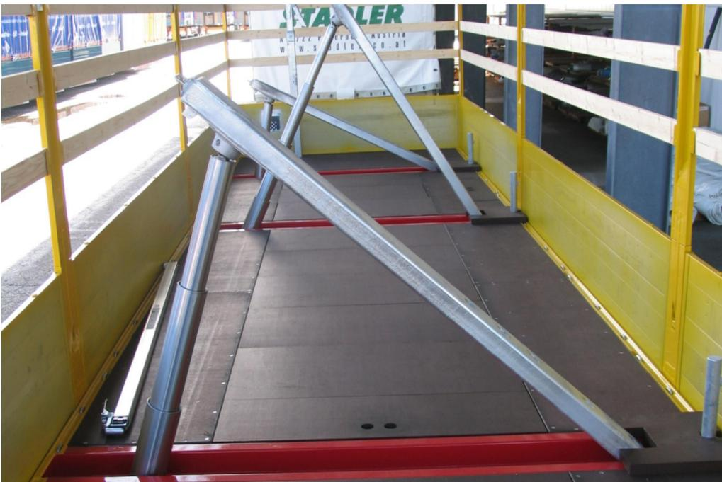
Hydraulische Schrägverladung zum Transport von Großformatblechen bis 3.300 mm Breite
