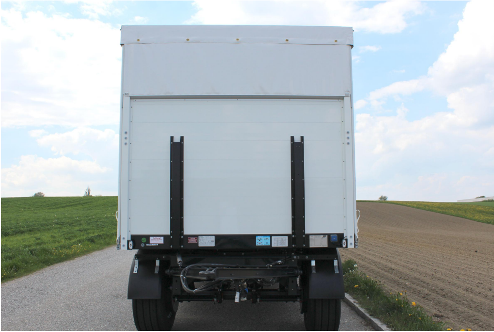
Verstärkte Aluminium Hohlprofil-Vorderwand mit integriertem Gerätehalter
