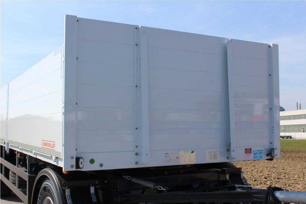
Fixe Aluminium-Hohlprofil-Vorderwand mit 2 Mittelstützen bis oben
