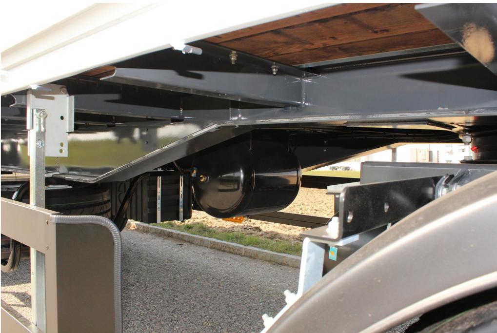
Verstärkte Rahmenkonstruktion für Punktbelastung 14 t auf 3 m im Schwerpunkt
