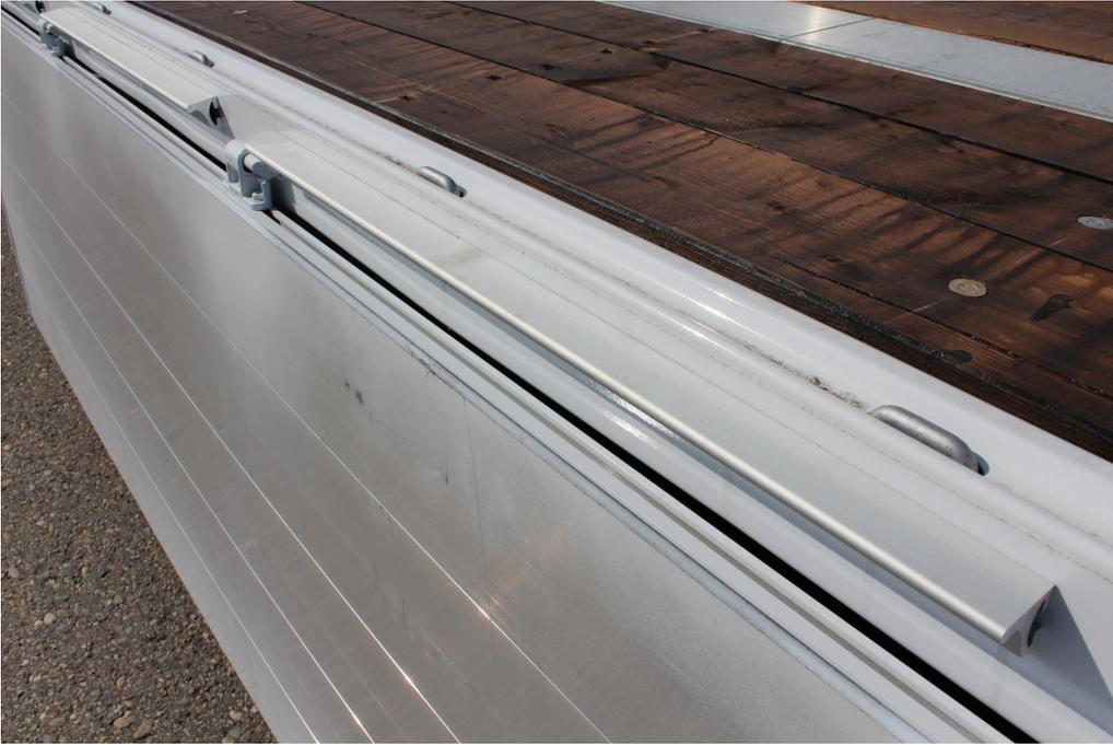
Zurrbügel-Außenrahmen mit 15 Paar versenkten Zurrbügeln für Ladungssicherung
