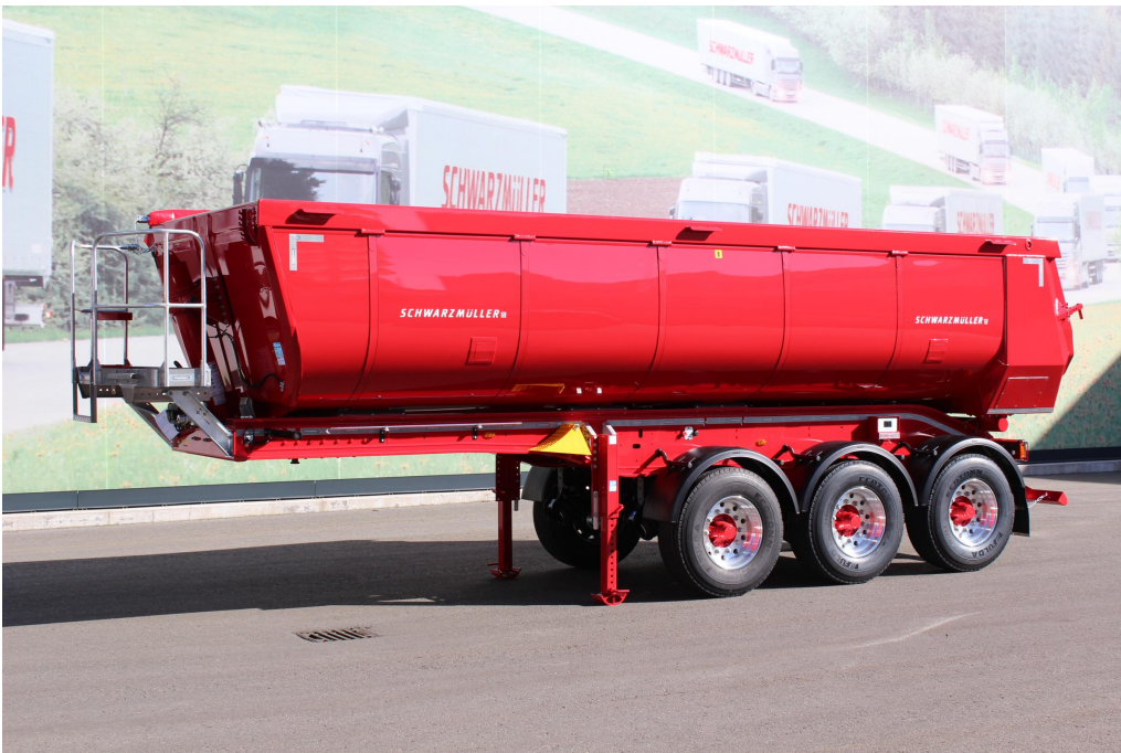
Aluminium-Trapez-Unterfahrerschutz klappbar, optional pneum. hochklappbar
