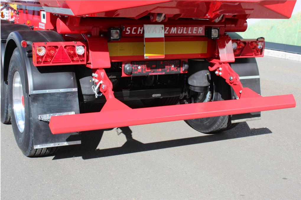
Aluminium-Trapez-Unterschutz klappbar, optional pneum. hochklappbar
