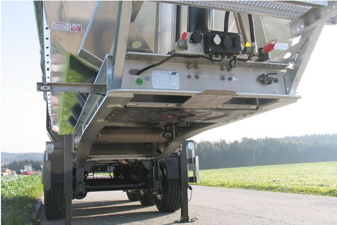
Stabile und verwindungssteife Aluminium-Fahrgestellkonstruktion mit zusätzlichen Torsionsrohren für einen erheblichen Nutzlastvorteil
