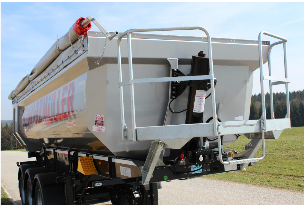
Optimale Lastverteilung durch schräge Vorderwand
