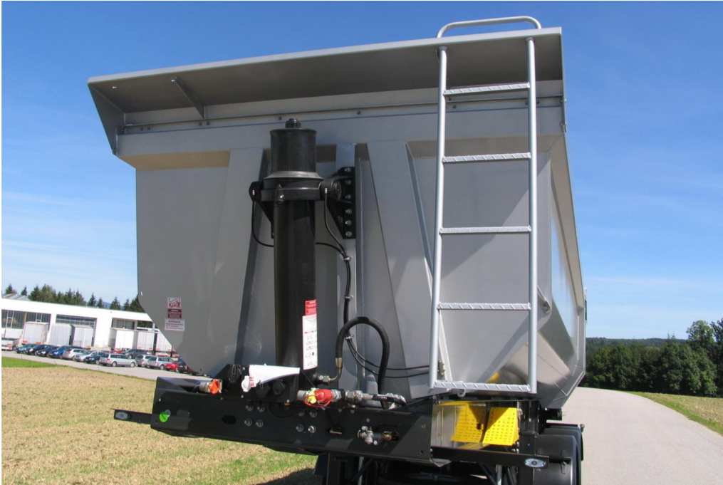
Optimale Lastverteilung durch schräge Vorderwand
