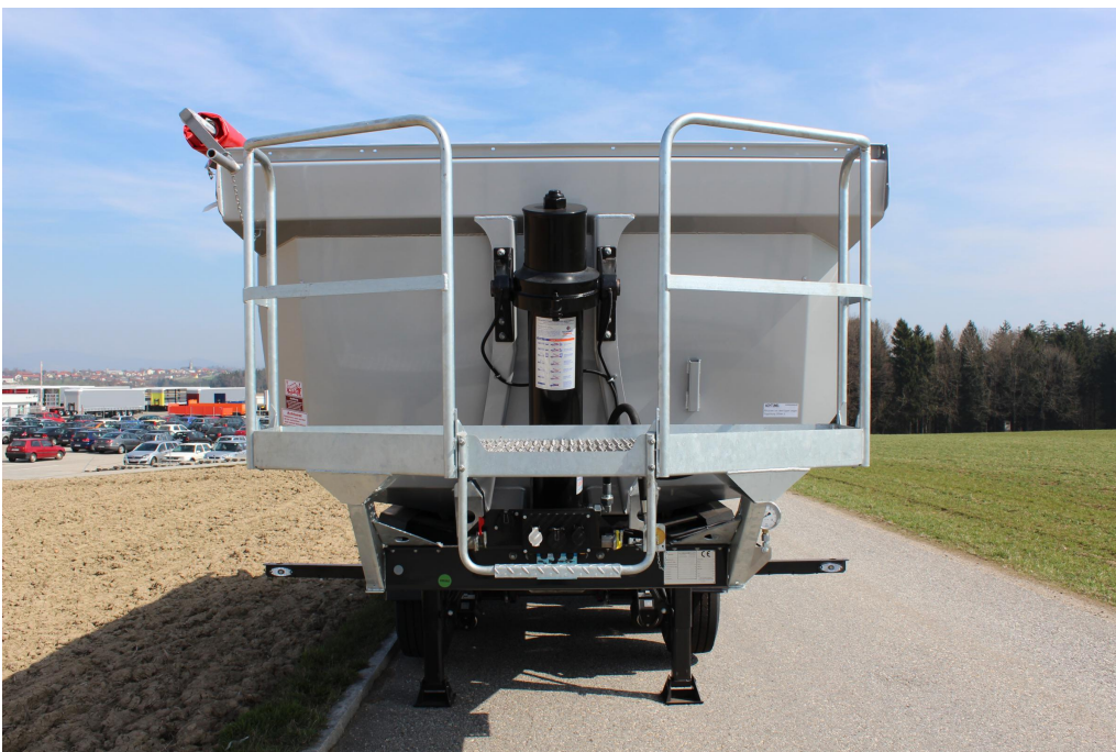
Rollverdeck – wahlweise manuell oder über elektrische Fernsteuerung bedienbar
